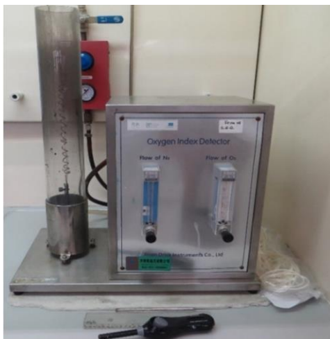
Figura 7 - Foto do equipamento de LOI.
