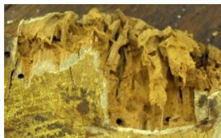
Figura 32 - Pormenor do efeito no suporte do ataque de insectos xilófagos.
