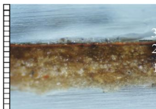
Figura 47 – Amostra onde é visível apenas o brilho da folha de ouro. (M.O., A40X, com luz transmitida)
