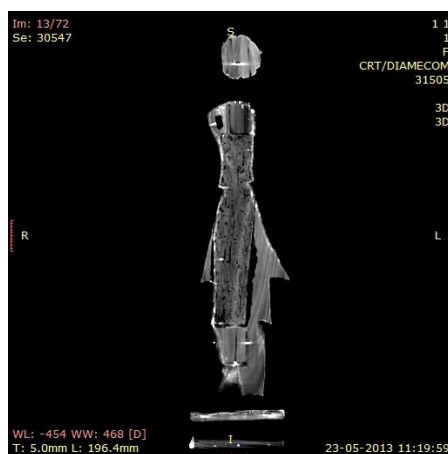
Figura 65 - Extensão do ataque de insectos xilófagos no bloco do verso da escultura.
