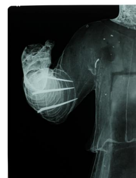
Figura 38 - Película radiográfica. Localização dos elementos metálicos.
