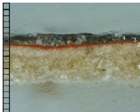
Figura 44 – Amostra estratigráfica (M.O., A 40X, com luz transmitida)
