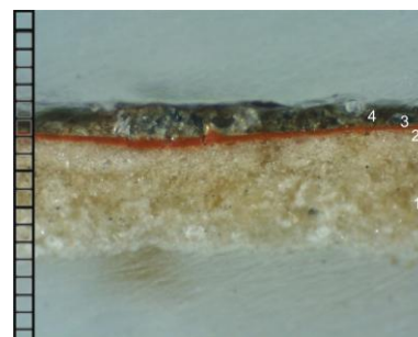
Figura 51 – Amostra estratigráfica. (M.O., A 40X, com luz transmitida.
