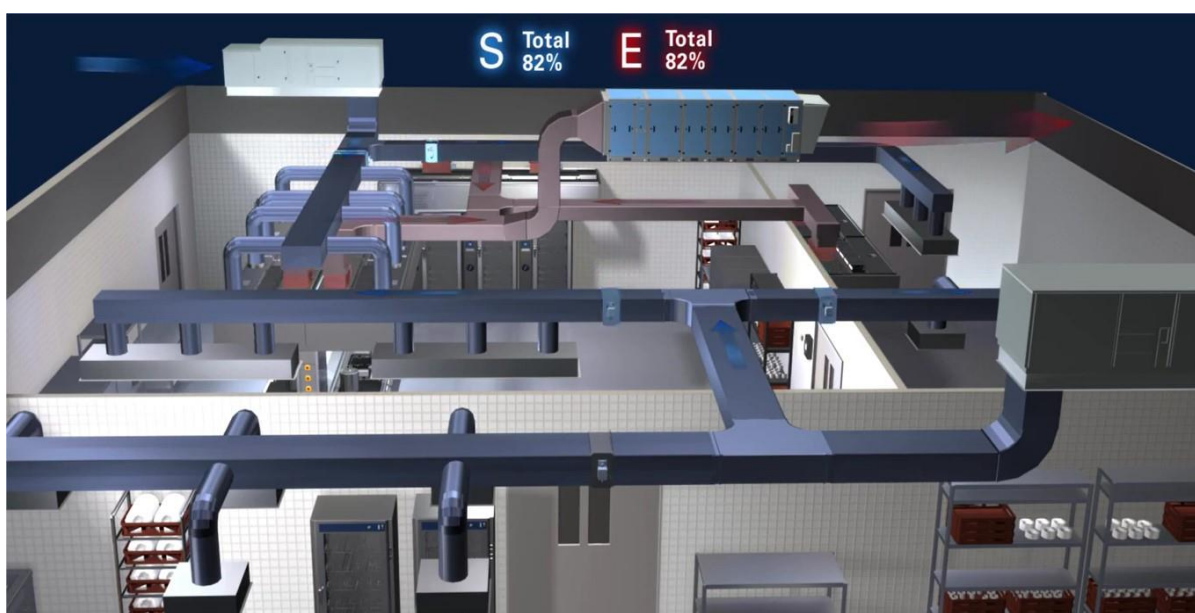
Figura 2.14 – Ventilação de Cozinha Profissional (3D) [5]
