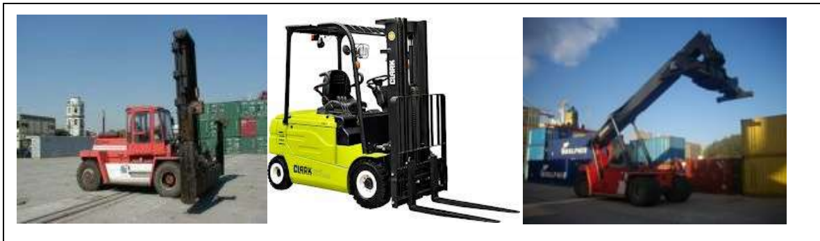
FIGURA 2 EMPILHADORES DE VÁRIOS TIPOS: FRONTAL COM SPREADER; FRONTAL DE GARFO ( FORKLIFT ); COM LANÇA E SPREADER ( REACH STACKER )
