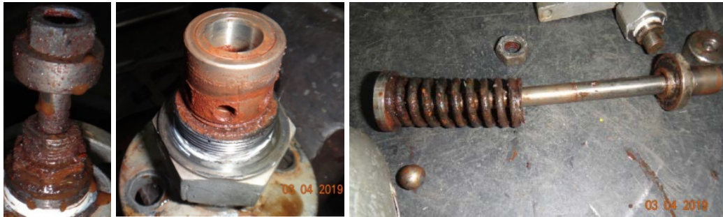
Figura 26 – Componentes internos da PSV3204 (fonte própria em contexto laboral).
