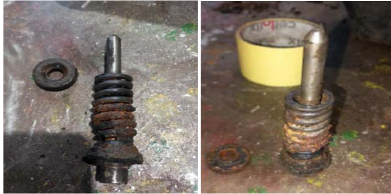
Figura 39 – Componentes internos da PSV1535 (fonte própria em contexto laboral).
