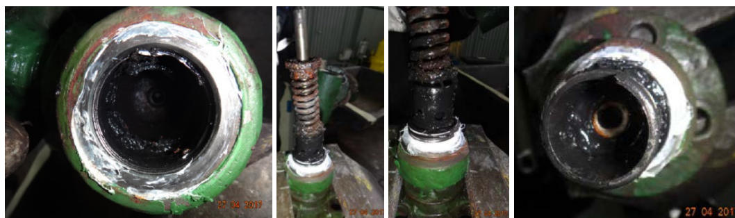
Figura 22 – Componentes internos da PSV2002 (fonte própria em contexto laboral).
