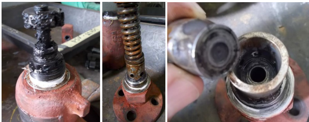
Figura 30 – Componentes internos da PSV21451 (fonte própria em contexto laboral).
