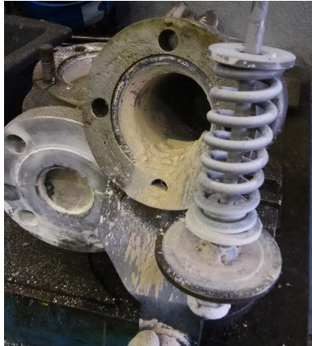
Figura 35 – Componentes internos da PSV7005 (fonte própria em contexto laboral).
