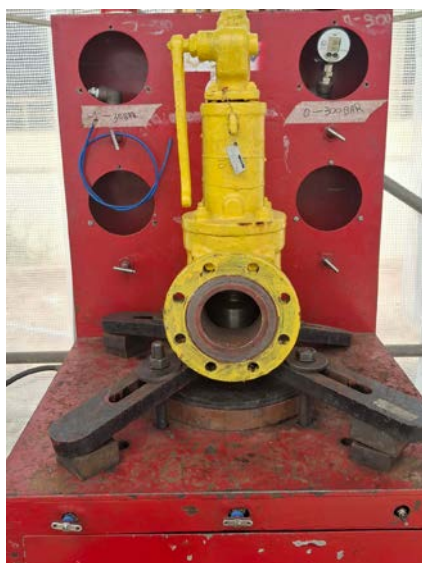
Figura 15 – Ensaio em bancada (fonte própria em contexto laboral).
