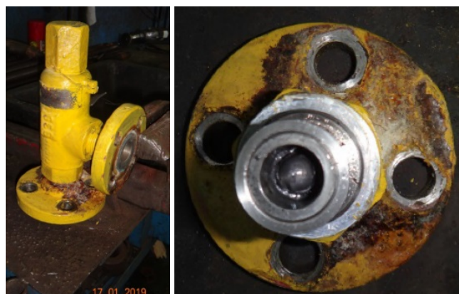
Figura 28 – Componentes internos da PSV3007 (fonte própria em contexto laboral).
