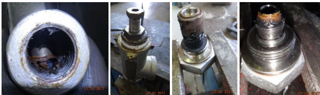
Figura 21 – Componentes internos da PSV8192 (fonte própria em contexto laboral).
