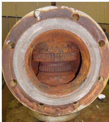
Figura 37 – Interior do corpo e anéis de regulação da PSV5604 (fonte própria em contexto laboral).
