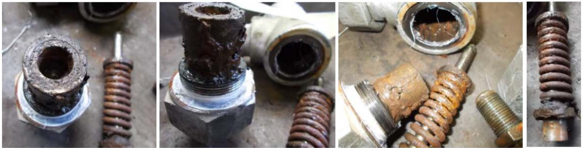
Figura 33 – Componentes internos da PSV2538 (fonte própria em contexto laboral).
