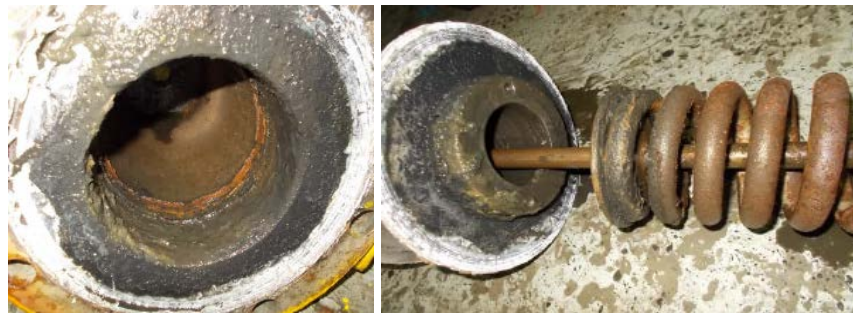
Figura 27 – Componentes internos da PSV3002C (fonte própria em contexto laboral).
