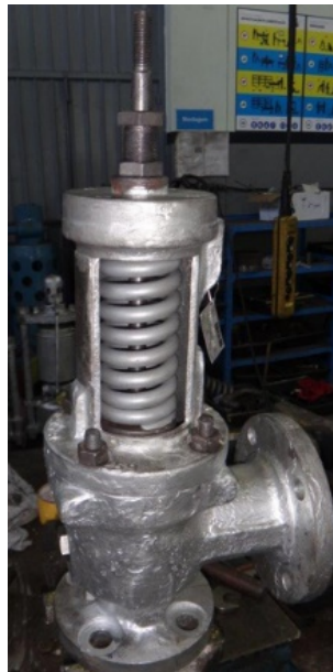
Figura 16 – Válvula de segurança em processo de desmontagem (fonte própria em contexto laboral).
