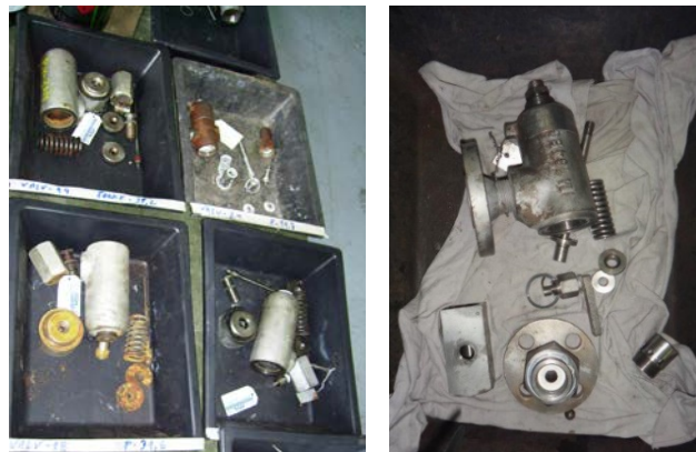
Figura 17 – Componentes de válvulas de segurança (fonte própria em contexto laboral).
