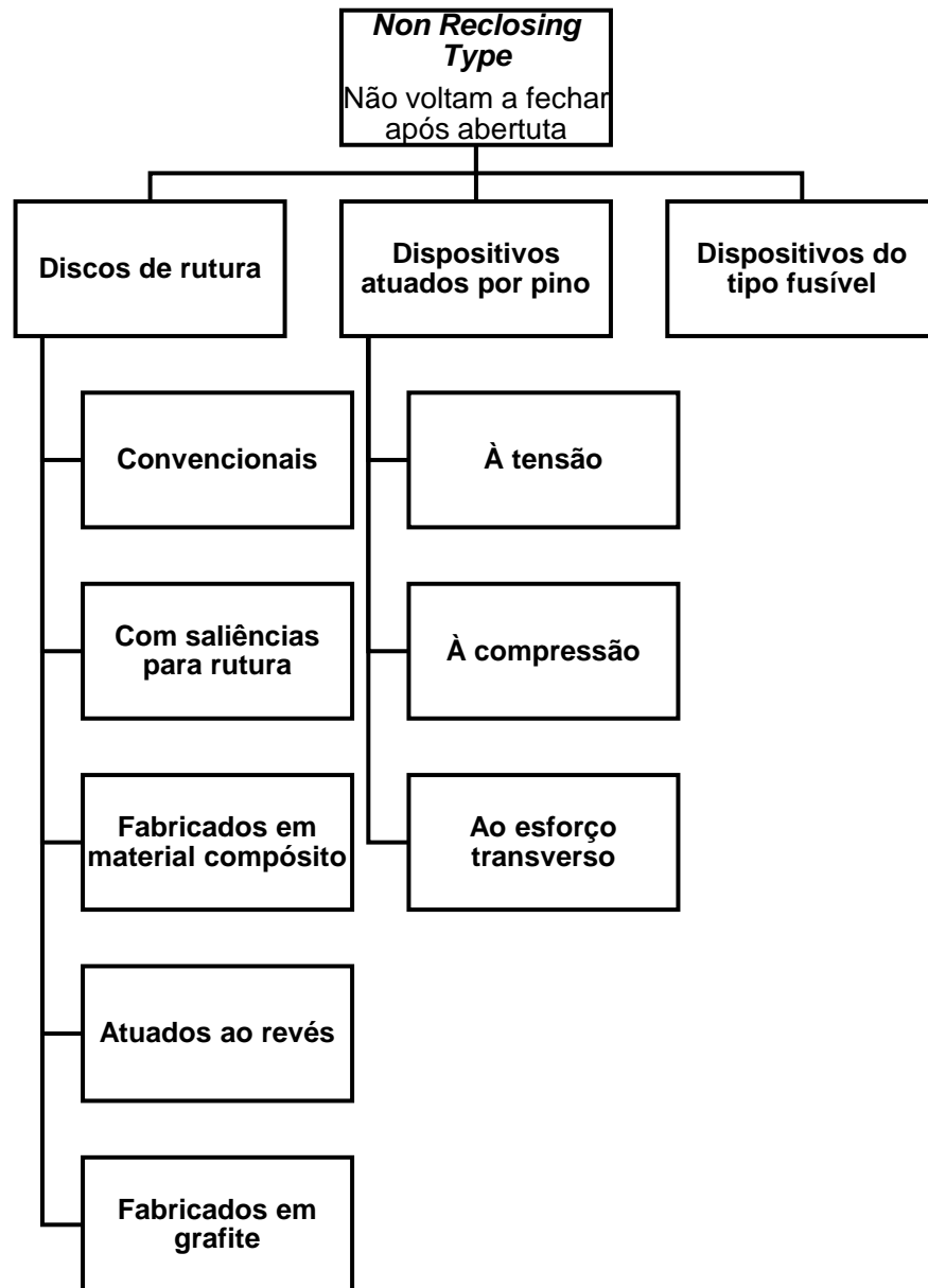
Figura 4– Dispositivos de alívio de pressão que após atuar não fecham (fonte própria)
