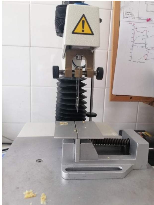
Figura 23: Texturómetro Stable Micro Systems, modelo TA.XTExpress e a adaptação ao dispositivo Craft Knife
