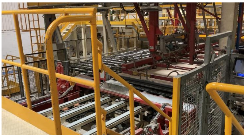
Figura 51. Colocação do Painel Cru
