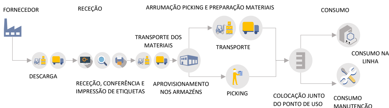
Figura 26. Processo Fluxo de Materiais
