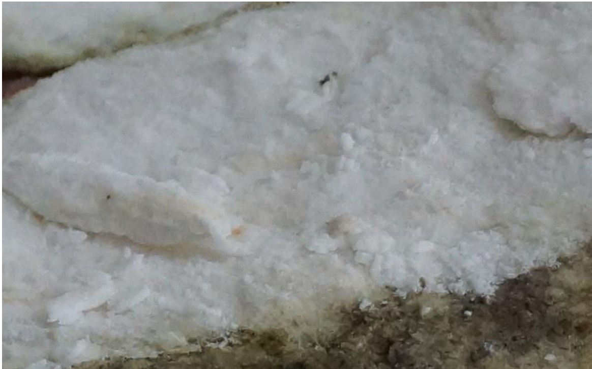
Figura 54: superfície de fratura onde se observa, em toda a sua extensão, o fenómeno zuccherino .
