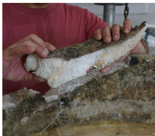
Figura 53: superfície de fratura ilustrativa da fragilidade do substrato pétreo.
