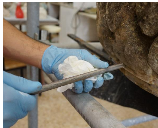
Figura 58: introdução de espigões roscados em aço inoxidável.
