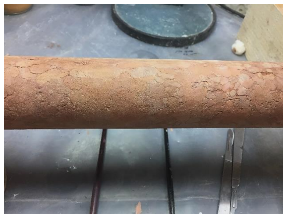
Figura 49: preenchimento de lacunas efetuado na “brecha” depois de reintegrado cromaticamente.
