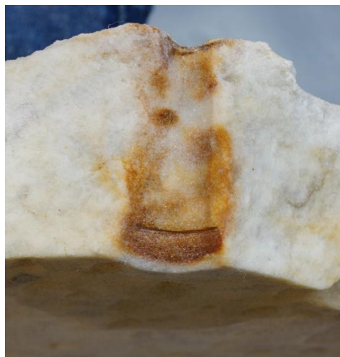
Figura 39: tonalidade do mármore 1 mm abaixo da superfície tratada.
