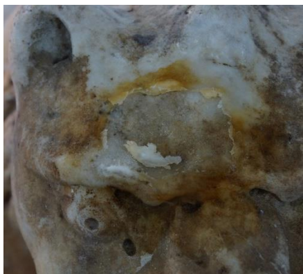
Figura 29: testes de remoção de manchas de pigmentação com solução de acetona.
