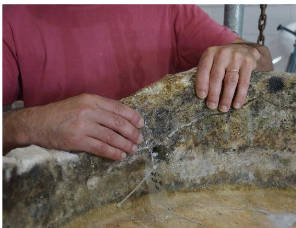
Figura 52: exemplo de fratura não detetada na fase de diagnóstico.
