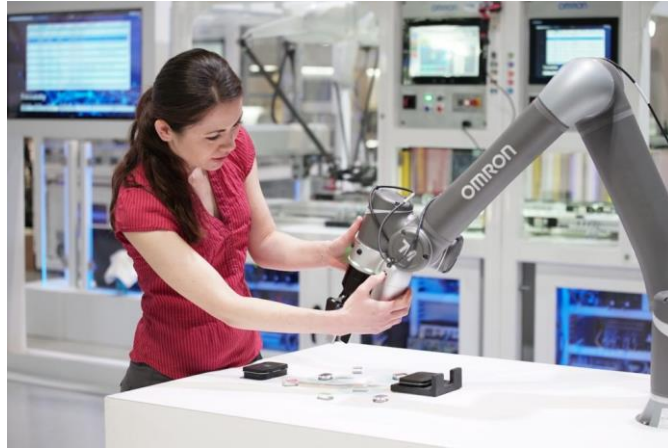
Figura 14 - Exemplo de programação de um Robô colaborativo 18
