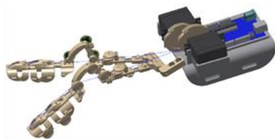
Figura 13– modelo do exoesqueleto para dois dedos [7]
