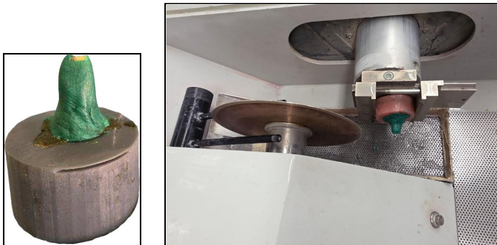
a) b) Figura 28 – Espécime fixados num suporte de corte para micrótomo: a) Espécime aglutinada por godiva e fixada na base de corte; b) Vista coronal da posição de corte do micrótomo.
