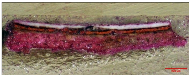
Fig. 26. Amostra 1: Tingida com o corante fucsina S| 40x| C.F. Victor Gaspar
