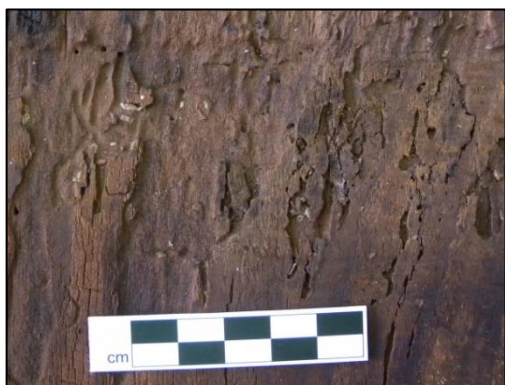
Fig. 80. Zona atacada onde se observa a fina camada de madeira frágil e os restos de pele das térmitas. AP.
