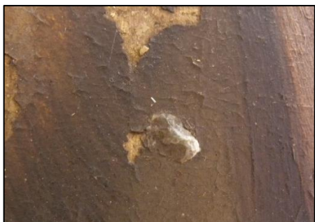
Fig. 112. Deposição de cera à superfície. A.P.
