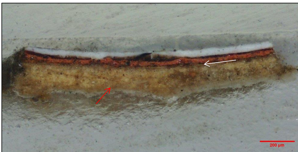
Fig. 25. Amostra 1: Dois estratos de preparação (seta vermelha) | imprimidura (seta branca) | 40x. C.F. Victor Gaspar
