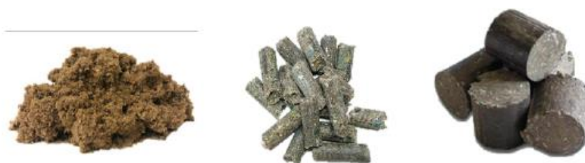
Figura 2.3 - Formas de produção de CDRs. Pode ver-se em fluffs (esquerda), pellets (centro) e bricks (direita).
