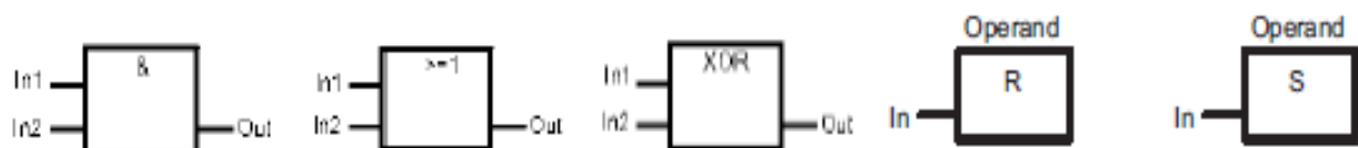
Figura 2.22 - Blocos de transição de FBD com diferentes funções assinaladas [74].
