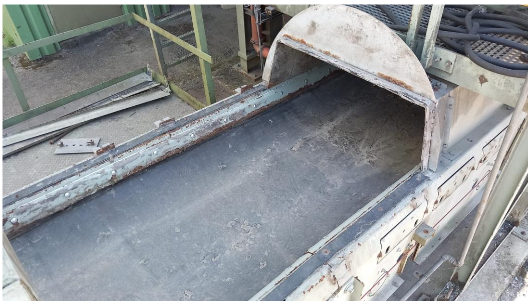
Figura 4.22 – Transportador de tela que recebe os CDRs da unidade de descarga. Constitui um ponto de leitura eficaz devido a ser aberto.
