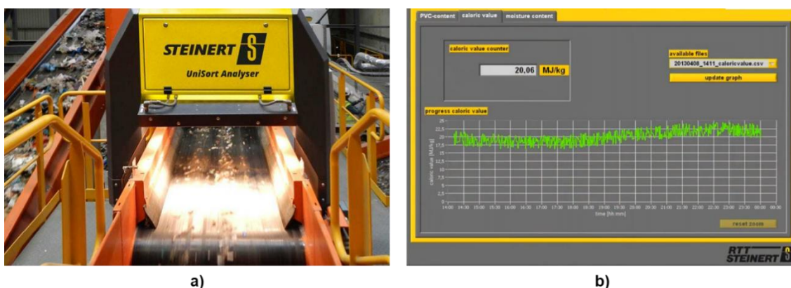
Figura 4.18 – Sensor Steinert para medição da qualidade de CDRs (a) e interface de controlo dos parâmetros (b).
