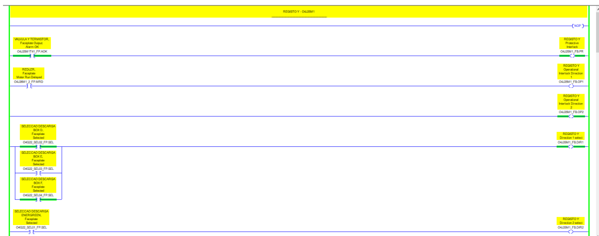
Figura 4.12 - Rotina criada para o posicionamento da válvula de desvio com as respetivas condições para a mudança de posição.
