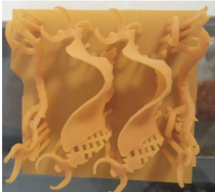
Figura 21 – Processo de Estereolitografia (Centre National d’Innovation et de Formation des Prothésistes Dentaire (CNIFPD), Guide de la CFAO Dentaire)
