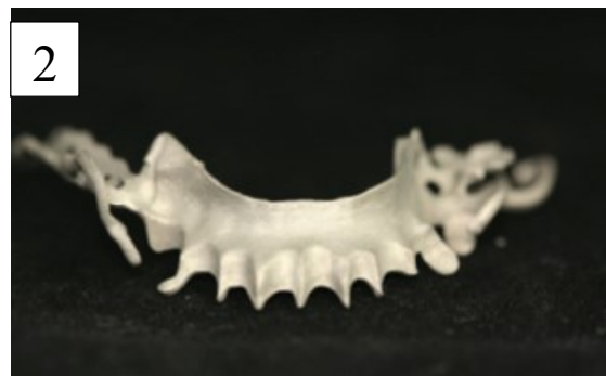
Figura 22 – Processo de Micro-fusão laser (CNIFPD), Guide de la CFAO Dentaire)
