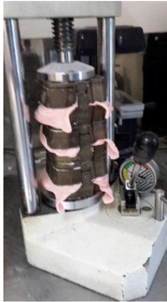
Figura 26 – Técnica da resina prensada.
