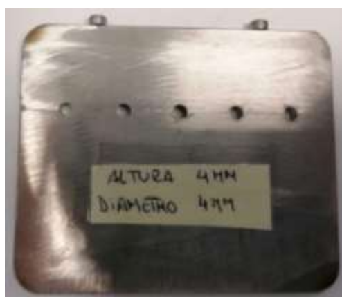
Figura 9 - Molde Metálico utilizado na confeção dos cilindros das diferentes resinas compostas.
