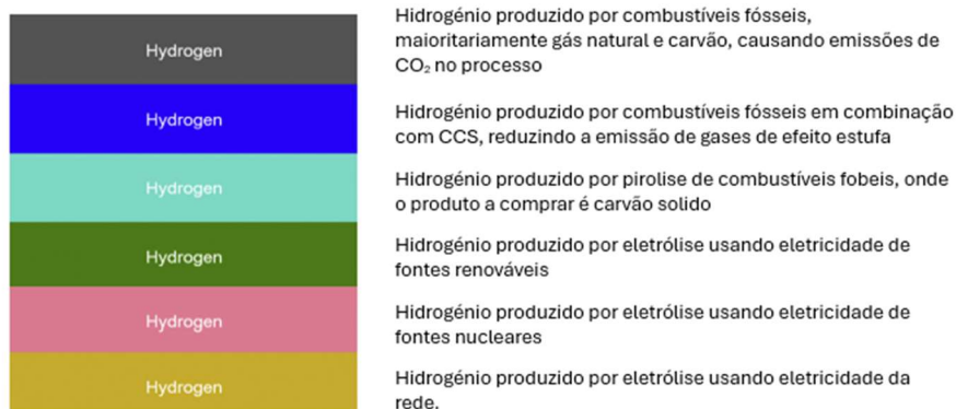
Figura 6. Cores do Hidrogénio 20
