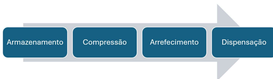
Figura 20. Esquema Simplificado de um posto de abastecimento de hidrogénio.
