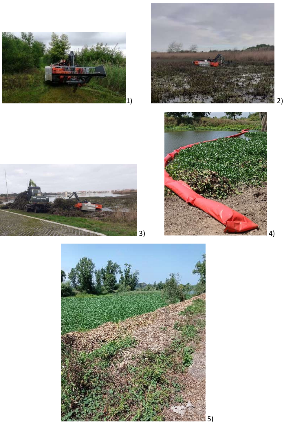
Figura 11- Veículo anfíbio a deslocar-se em terreno firme (1), veículo anfíbio a retirar invasora do leito do rio (2), a descarregar em camião para o transporte e descarregar em pilha (3), barreira de contenção (4) aspeto do jacinto-de-água antes da floração (5). Fontes: https://freguesiadetocha.pt/ver_noticia/1056 , https://www.cm-mira.pt/node/2348 , https://www.cm-agueda.pt/uploads/document/file/2490/Processo_de_Controlo_do_jacinto-de-agua_na_Pateira_de_Fermentelos_PT-EN.pdf
