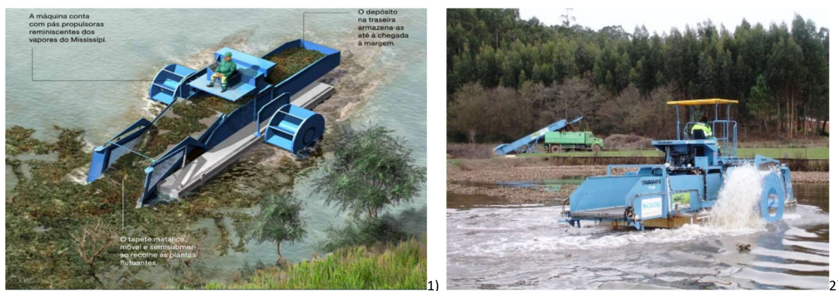
Figura 12- Modelo de ceifeira aquática usada na pateira de Fermentelos, Águeda, Portugal. Fontes: 1) António Luís Campos & National Geographic Portugal - factualidade e Ciência/ 2020; 2) Dâmaso (2008)
