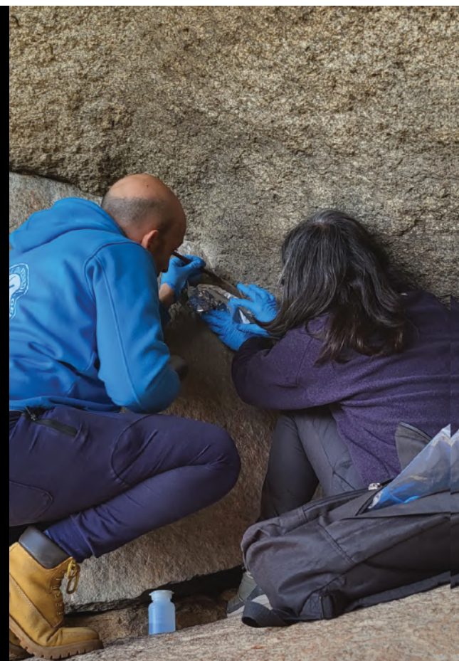
Fig. 7 (em cima, à esquerda) – Exame de espectroscopia Raman no painel 1 da rocha 60 de Ribeira de Piscos, realizado por Pablo Barreiro da Universidade de Vigo.
