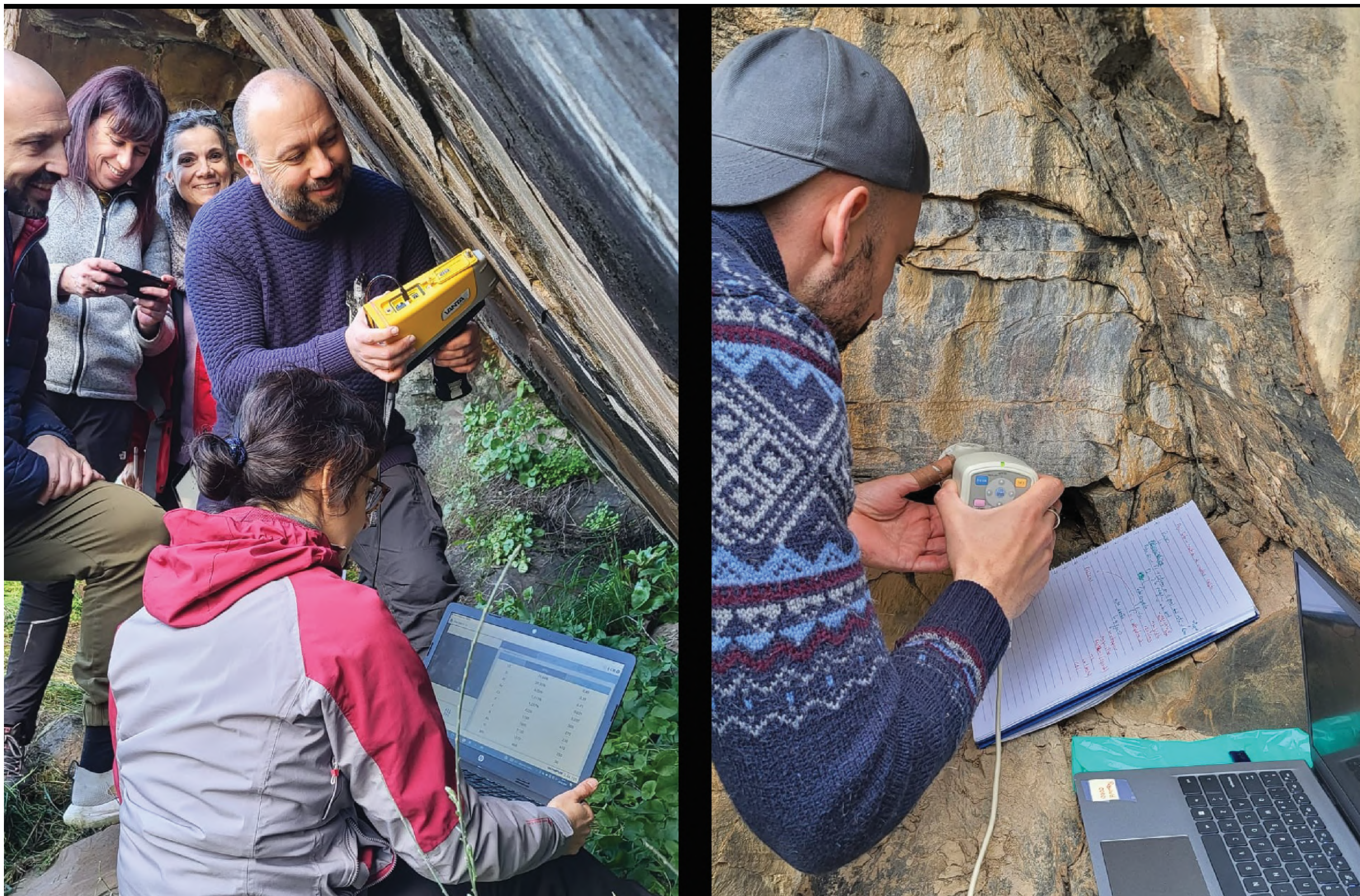
Fig. 6 – Exames realizados em in situ pela Universidade de Vigo em colaboração com o Incipit-CSIC - Consejo Superior de Investigaciones Científicas. À esquerda: espectrometria de fluorescência de raios X (FRX) no painel 2 do abrigo do Poço Torto, realizado por Lucía Pereira e Lois Armada, com Santiago Pozo-António, Lara Bacelar Alves e Teresa Rivas Brea; à direita: espectrofotometria da cor no painel 3 da rocha 60 de Ribeira de Piscos, realizado por Santiago Pozo-António.
