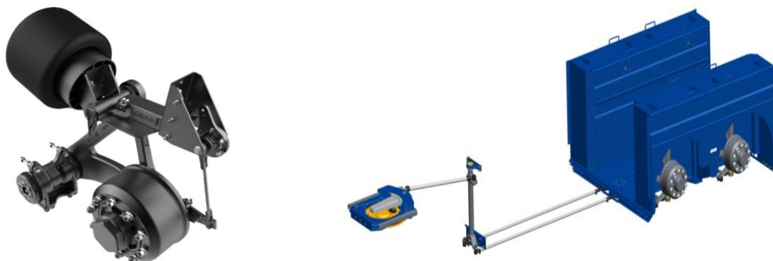
Figura 12 - Suspensões a ar – LVO e TF-VO. (Fonte: Folheto Informativo TRIDEC,2021)
