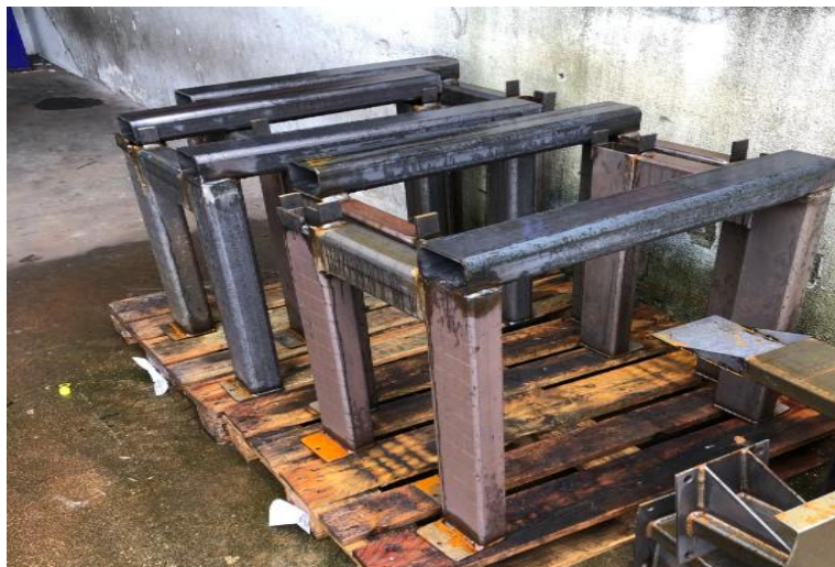
Figura 27 - Exemplos das proteções dos terminais de picagem.
