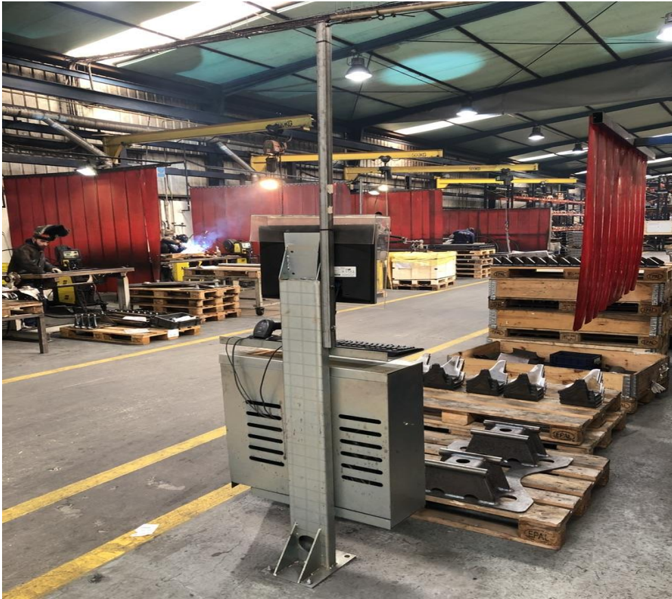
Figura 24 - Terminal de picagem em utilização.
