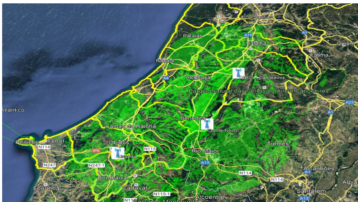
Figura 10 As primeiras três torres de videovigilância e a sua cobertura a 20KM (Fonte dos dados: CICLOPE, 2023).
