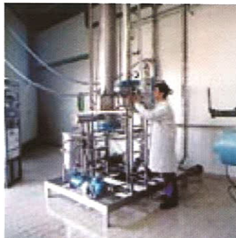
Evaporador, à escala piloto, utilizado na recuperação de produtos de origem marinha.
