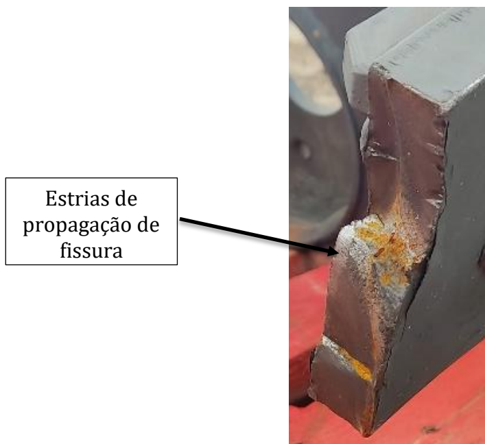
Figura 5.28 – Secção transversal da fratura.
