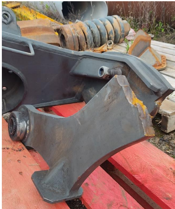
Figura 5.27 – Falha mecânica ocorrida no berço do processador.
