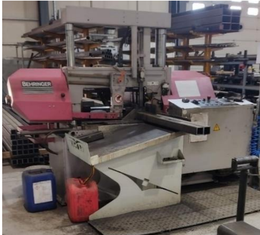
Figura 3.4 – Serrote automático para corte de tubos e varões da Cutplant Solutions , S.A.
