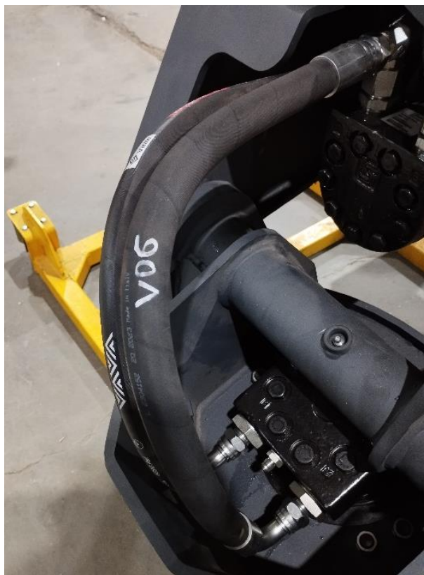
Figura 5.26 – Alimentação dos motores hidráulicos de um dos lados do processador.
