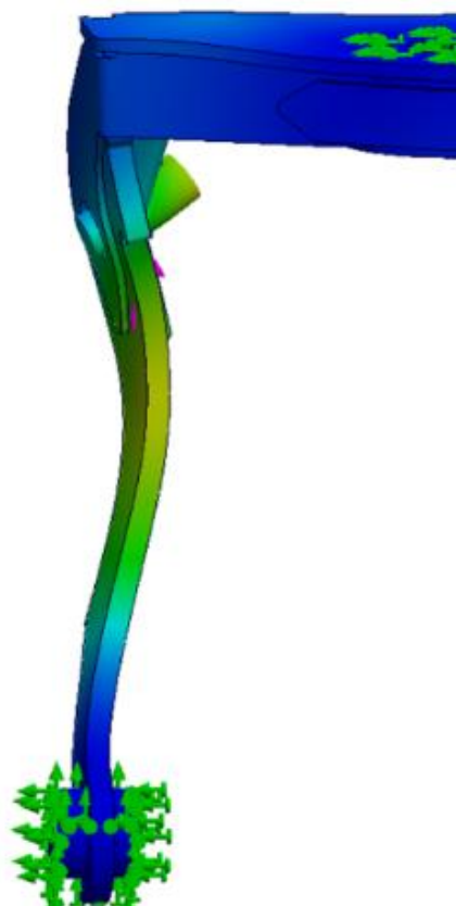
Figura 5.40 – Representação exagerada da deformação da estrutura no estudo da primeira configuração.
