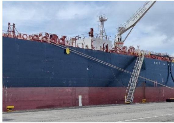
Figura 29 – Escada de portaló Fonte: Autor, 2023
