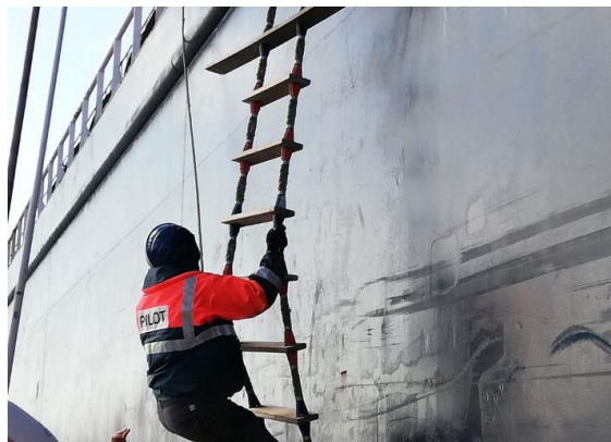
Figura 20 – Desembarque por escada quebra-costas Fonte: Autor, 2023
