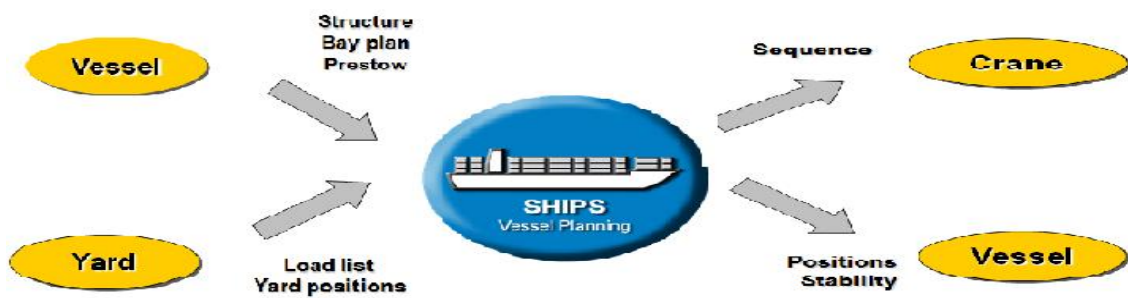
Figura 21- Diagrama de procedimento de planeamento dos navios pelo terminal
