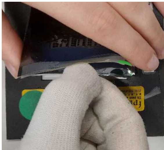
Figura 14: Exemplo do processo cuidadoso de abertura da manga de polipropileno e de retirada do slide.
