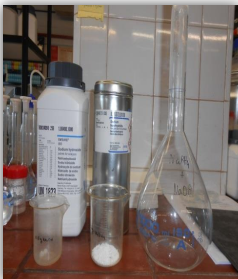
Figura 29. Preparação de soluções NaBH 4 com NaOH e HCl a 3% (v/v). Foto: Autora.
