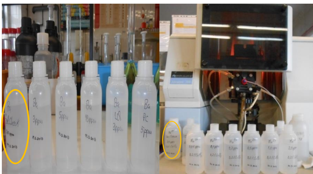
Figura 23. Exemplos de Solução Padrão “Mãe” ou Solução Stock ou a Solução Check de Bário (Ba) e Manganês (Mn) que foram preparadas no LAM .Fonte: Autora.
