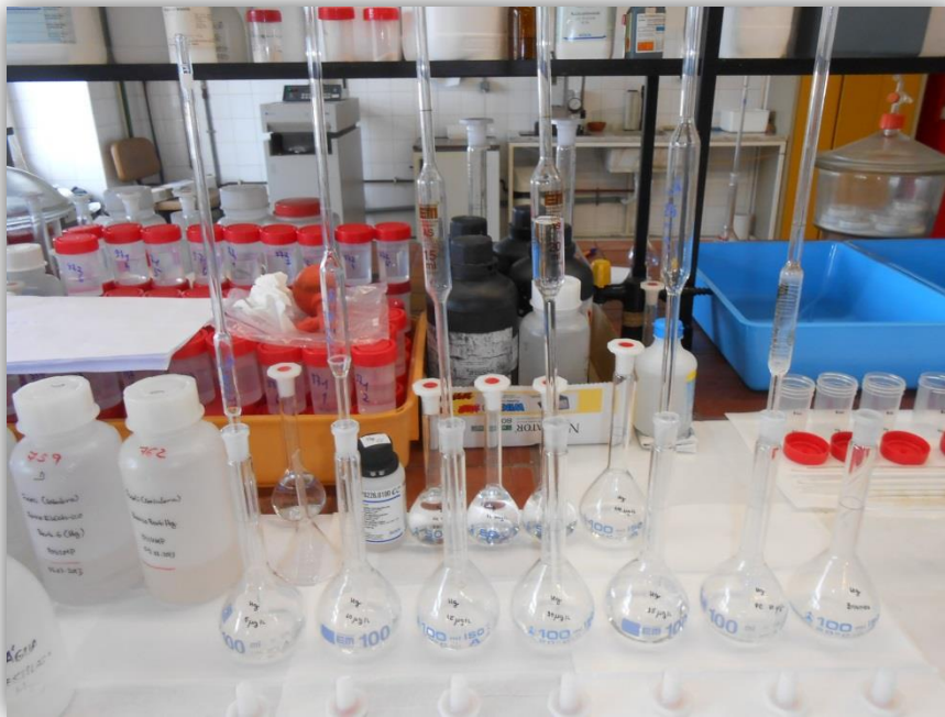
Figura 27. Preparação de padrões de Hg (5 µg/l; 10 µg/l; 15 µg/l; 20µg/l; 25 µg/l) para balões de 100ml em ppb (µg/l). Foto: Autora.
