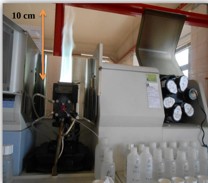
Figura 11. Queimador de fluxo laminar para chama com oxidante e combustível acetileno/óxido nítrico, respectivamente, analisando o elemento Alumínio, com uma chama de cerca de 10 cm de comprimento. Fonte: Autora.
