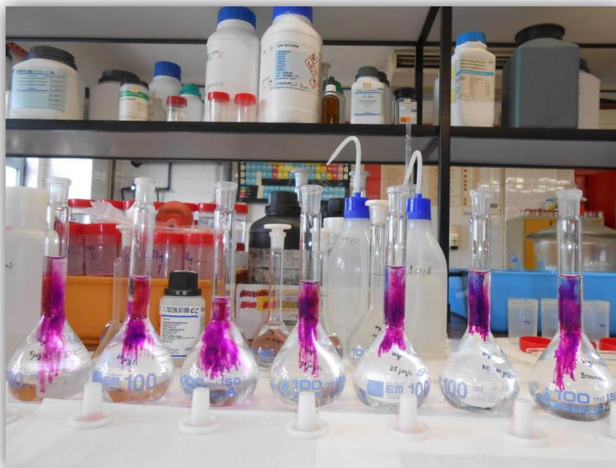
Figura 28. Preparação de padrões de Hg (5 µg/l; 10 µg/l; 15 µg/l; 20µg/l; 25 µg/l) para balões de 100ml em ppb (µg/l) com adição 1% HCl e duas gotas de KMnO 4 a 5%. Foto: Autora
