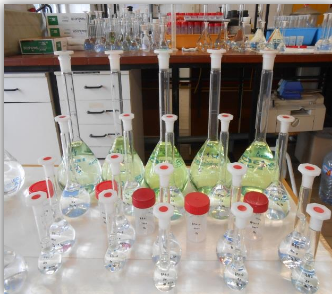
Figura 25. Fotografia mostrando alguns balões de diluição (devidamente numerados) com as soluções provenientes de cada amostra, neste caso a matriz são matérias-primas, nomeadamente cromites. Fonte: Autora.
