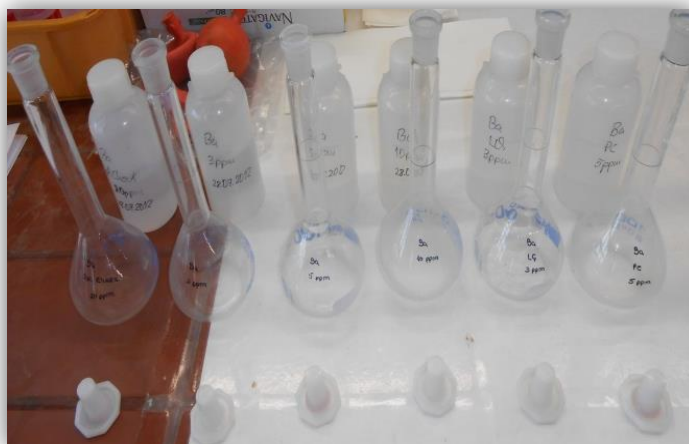
Figura 24. Preparação de padrões de Ba (3 ppm; 5 ppm; 10 ppm) para balões de 100ml em ppm (mg/l) através da solução Check. Foto: Autora.
