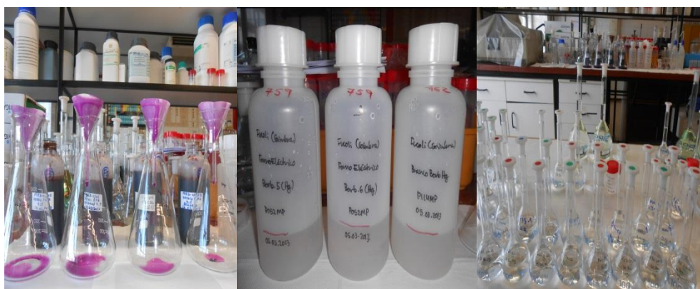
Figura 30. Fotografia mostrando alguns balões de diluição (devidamente numerados) com as soluções provenientes de cada amostra, neste caso a matriz são matérias-primas e efluentes gasosos.
