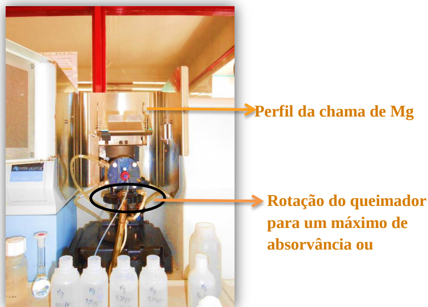
Figura 9. Queimador e perfil da chama de Mg em Espectrofotometria de Absorção Atômica por Chama. Fonte: Autora.
