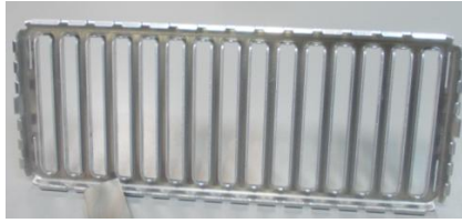
Figura 1.1- Chapa testa produzida por uma ferramenta progressiva
