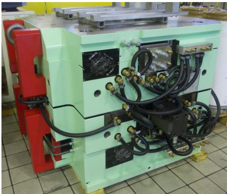
Figura 1.6- Molde para injeção de plástico montado na J. Deus - Setúbal
