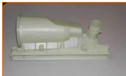
Figura 1.4-Peça obtida por injeção de plástico através de um molde
