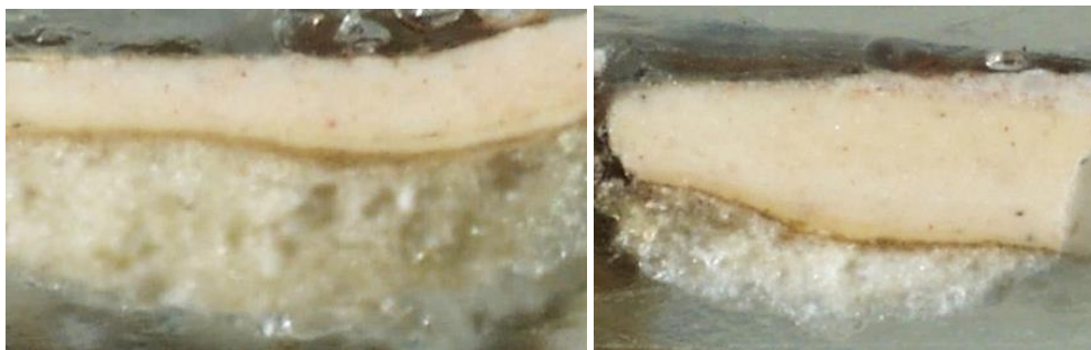
Figuras 83 e 84 - Estratigrafias (Amostra C1 e C2 – Anexo 9) da carnação do rosto dos querubins do lado esquerdo e direito da imagem com ampliação de 40x. C.F. Vitor Gaspar (IPT).
