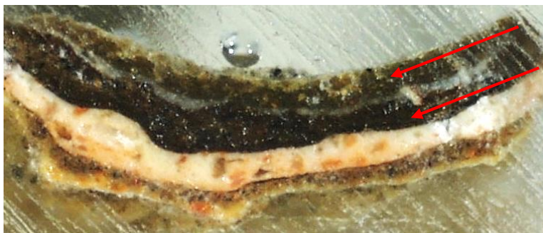
Figura 107 - Estratigrafia (Amostra J2 – Anexo 2) com ampliação de 40x mostrando uma repolicromia na zona do cabelo. C.F. Vitor Gaspar (IPT).
