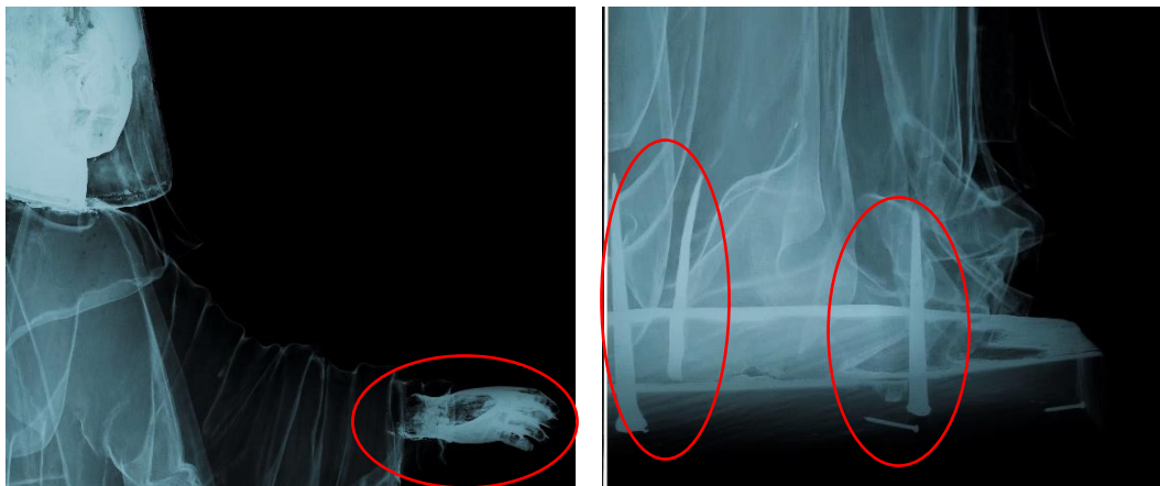
Figuras 50 e 51 – Radiografias do encaixe macho e fêmea dos pulsos e cavilhas de fixação do corpo da escultura à base. C.F. Gonçalo Figueiredo (IPT).
