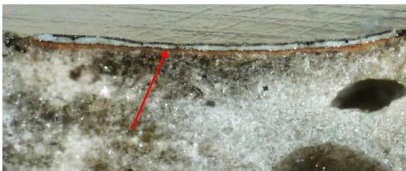
Figura 90 – Estratigrafia (Amostra C6 – Anexo 9) da manga da túnica do lado esquerdo da imagem com ampliação de 40x. C.F. Vitor Gaspar (IPT).
