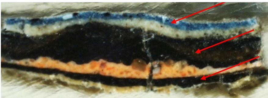
Figura 106 – Estratigrafia (Amostra J8 – Anexo 2) do livro com ampliação de 40x mostrando as duas repolicromias. C.F. Vitor Gaspar (IPT).
