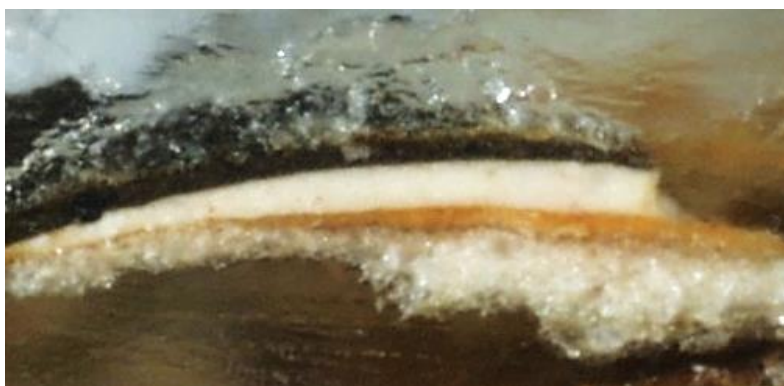
Figura 85 – Estratigrafia (Amostra C7 – Anexo 9) da área do cabelo com ampliação de 40x. C.F. Vitor Gaspar (IPT).
