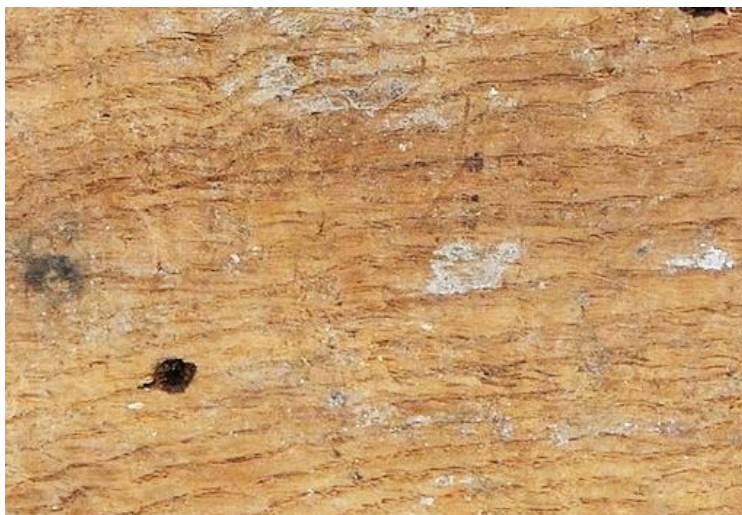
Figura 43 – Fotografia à vista desarmada da parte inferior da base da escultura da Santa Abadessa , mostrando as mesmas características do castanho ( Castanea spp.). A.P.
