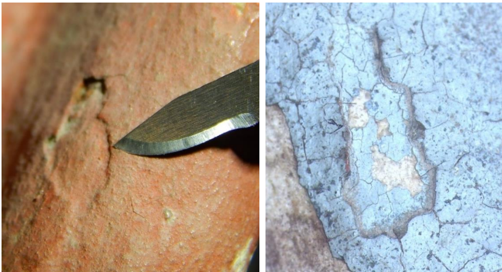
Figuras 104 e 105 – Detalhe da repolicromia diretamente sobre o suporte no local das lacunas formando depressões. Macrofotografia com ampliação de 16x. A.P.
