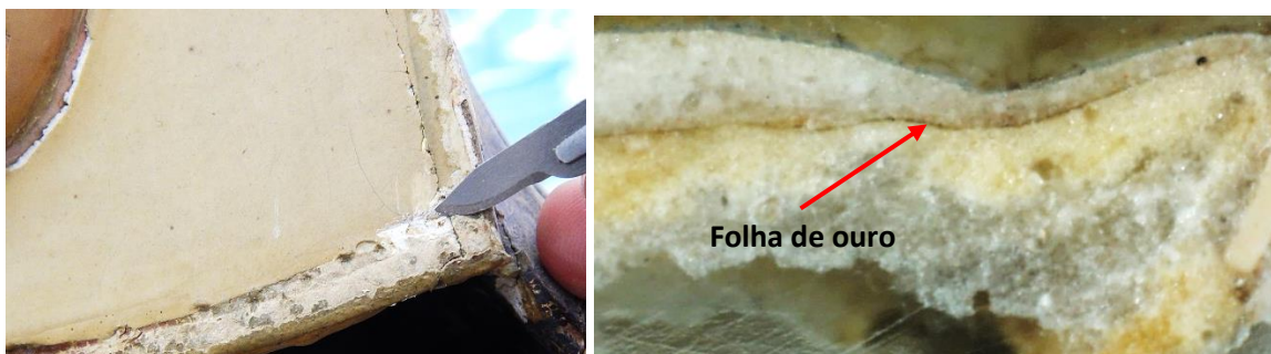
Figuras 114 e 115 – Beira da coifa e estratigrafia (Amostra I3 – Anexo 5) com ampliação de 40x mostrando a camada de folha de ouro abaixo da camada branca. C.F. A.P. e Vitor Gaspar (IPT).
