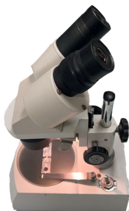
Figura 18. Microscópio ótico (EMZ-8TR, MejiTechno Co., Ltd., Saitama, Japan).
