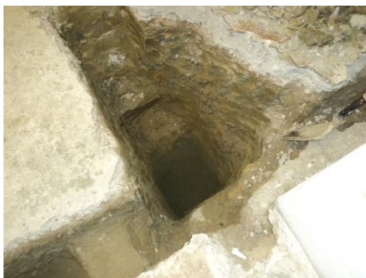
Figura 83 – Sondagem efetuada ao nível da cave para visualização do solo
