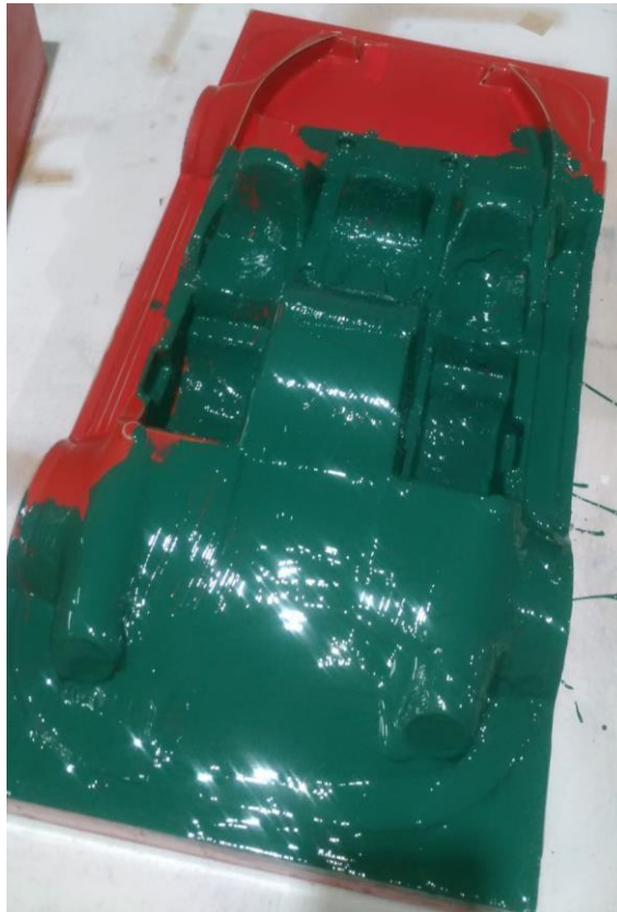
Figura 5.6 - Exemplo da aplicação do Gel Coat na matriz do molde da cobertura do protótipo da gaivota de água.
