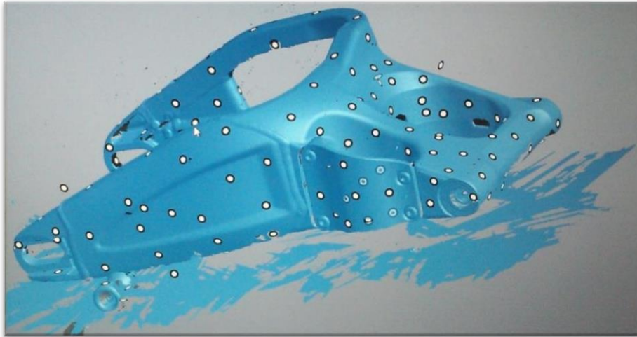
Figura 2.1 - Exemplo de uma Digitalização 3D, com apresentação da nuvem de pontos que define a geometria. coroflot (2015)
