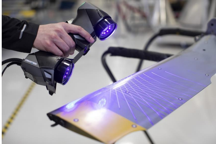
Figura 2.7 - Exemplo de uma digitalização 3D sem contacto físico por triangulação ótica. creaform3d (2020)
