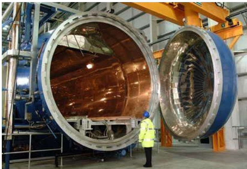
Figura 4.9 - Representação do processo moldação em autoclave (Lopes, 2009).
