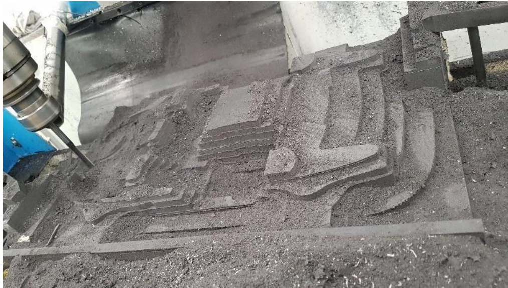
Figura 5.3 - Operação de desbaste do bloco de MDF, referente à matriz de cobertura do protótipo da gaivota.
