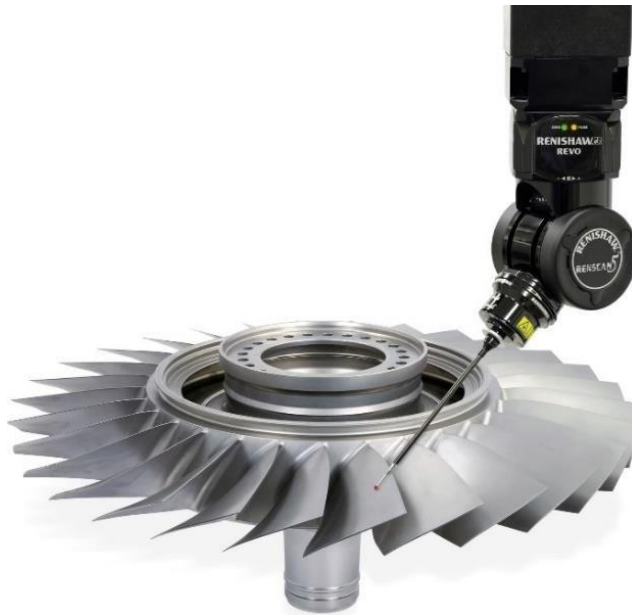
Figura 2.6 - Medição de peça ponto a ponto, através de uma sonda de contacto. renishaw (2019)
