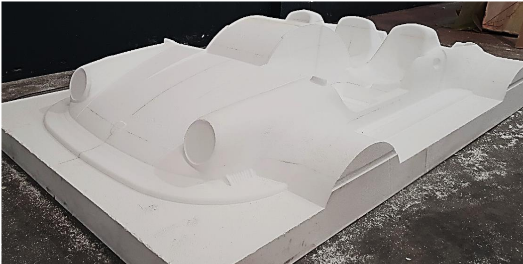
Figura 5.11 - Resultado da operação de maquinagem da matriz do molde da cobertura, em EPS, da gaivota de água para produção do modelo final.
