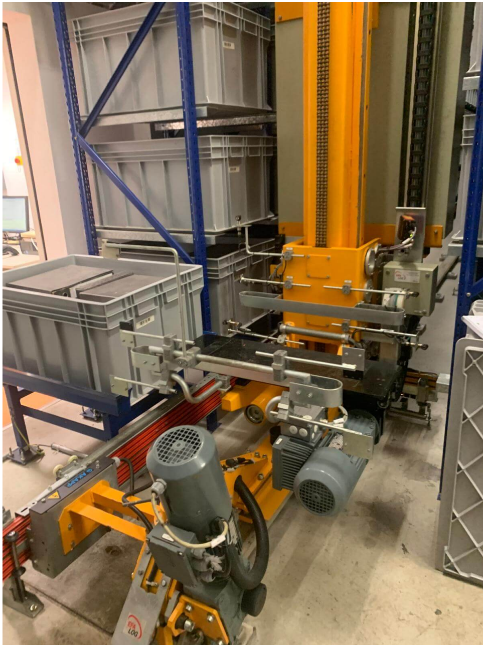
Figura 3.5: Estrutura do miniload .
