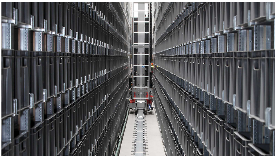
Figura 2.2: Sistema Mini Load AS/RS com grua de armazenamento e recuperação para caixas e contentores[7].
