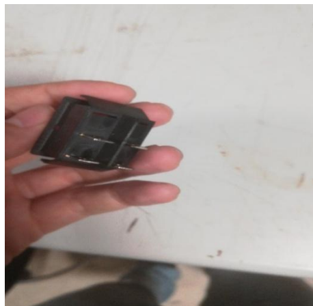
Figura 86 - Substituição de interruptor ON/OFF
