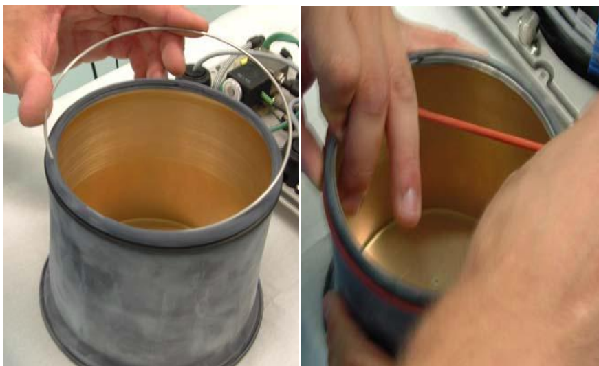
Figura 61 - Substituição da membrana de rolamento e o-ring do módulo VGC
