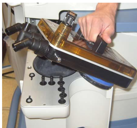
Figura 52 - Troca de membrana rolante
