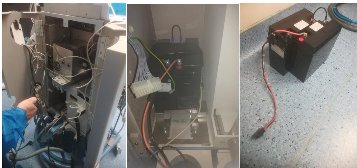
Figura 62 - Sequência para substituição de baterias
