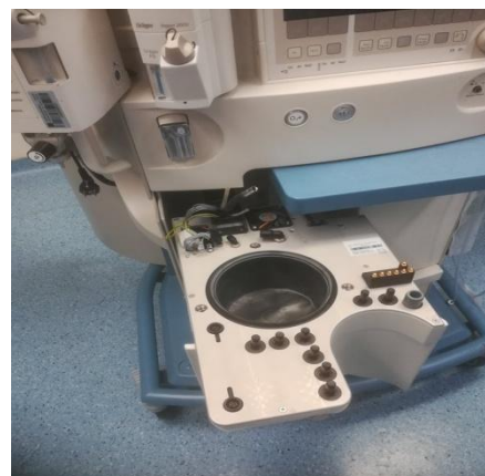
Figura 52 - Troca de membrana rolante
