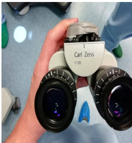
Figura 87 - Lente e roldana do microscópio cirúrgico danificados
