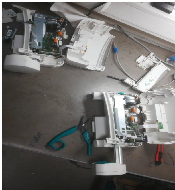
Figura 69 - Seringa bloqueada com suporte aberto
