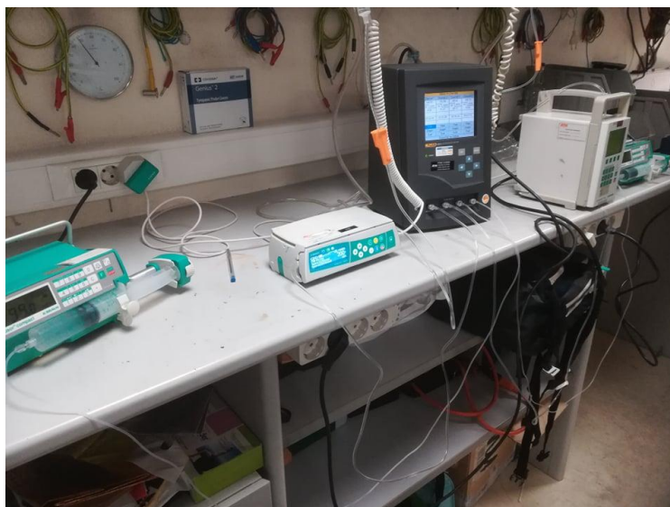
Figura 32 - Equipamento de teste de infusão ligado a 2 bombas e 2 seringas infusoras
