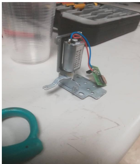
Figura 70 - Avaria de bloqueio de seringa com pistão danificado
