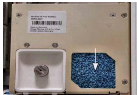
Figura 50 - Troca de filtros
