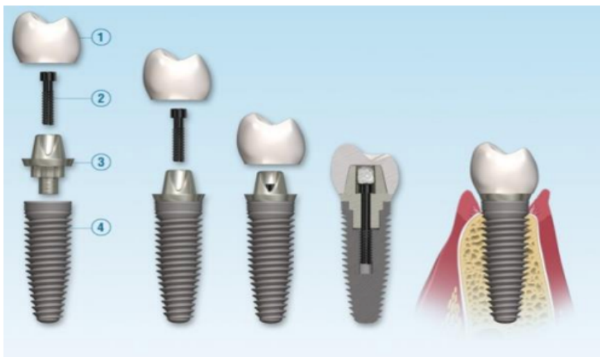
Figura 6: Componentes de um implante dentário: 1 - coroa; 2 - parafuso de fixação da coroa; 3 - pilar protético; 4 - implante propriamente dito (Adaptado de: Miguel & Borges, 2015).
