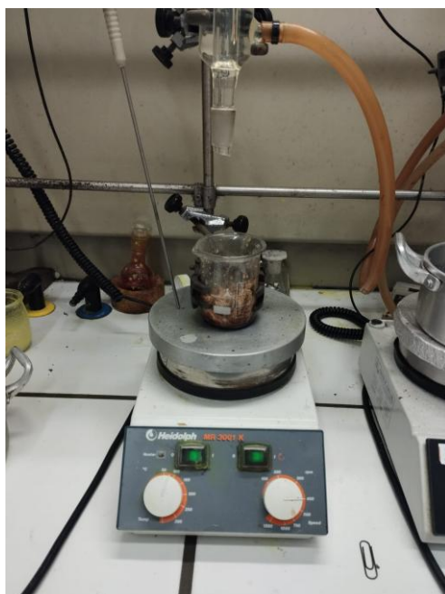
Figura 10 – Montagem experimental onde ocorreu a ativação química da biomassa
