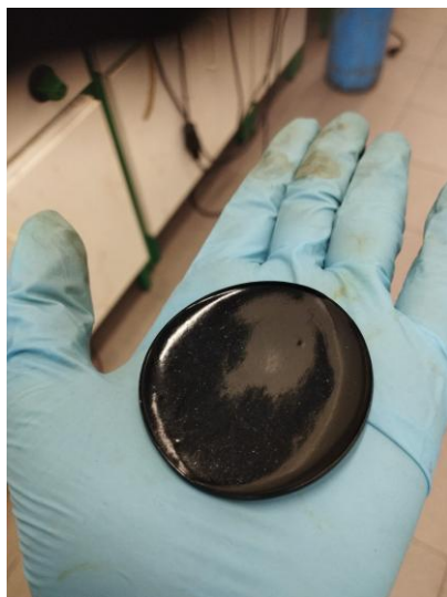
Figura 13 - Membrana de PVA
