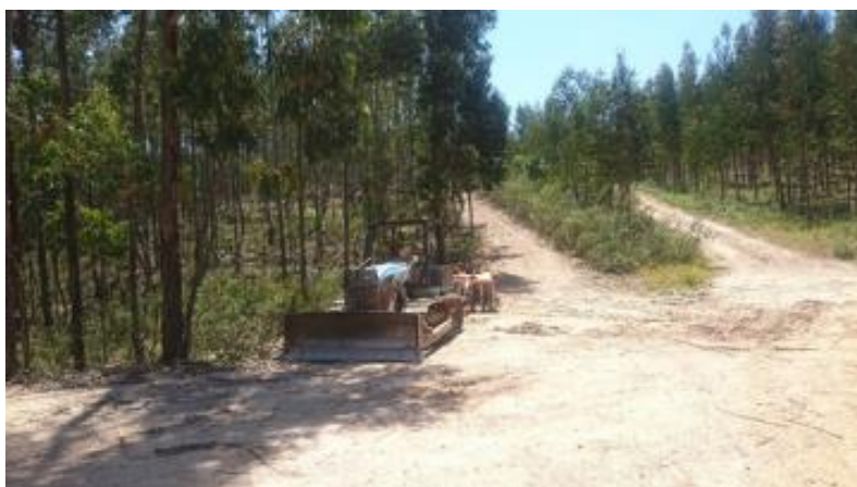
Fotografia 4 – Trator de rasto com grade para abrir aceiro
