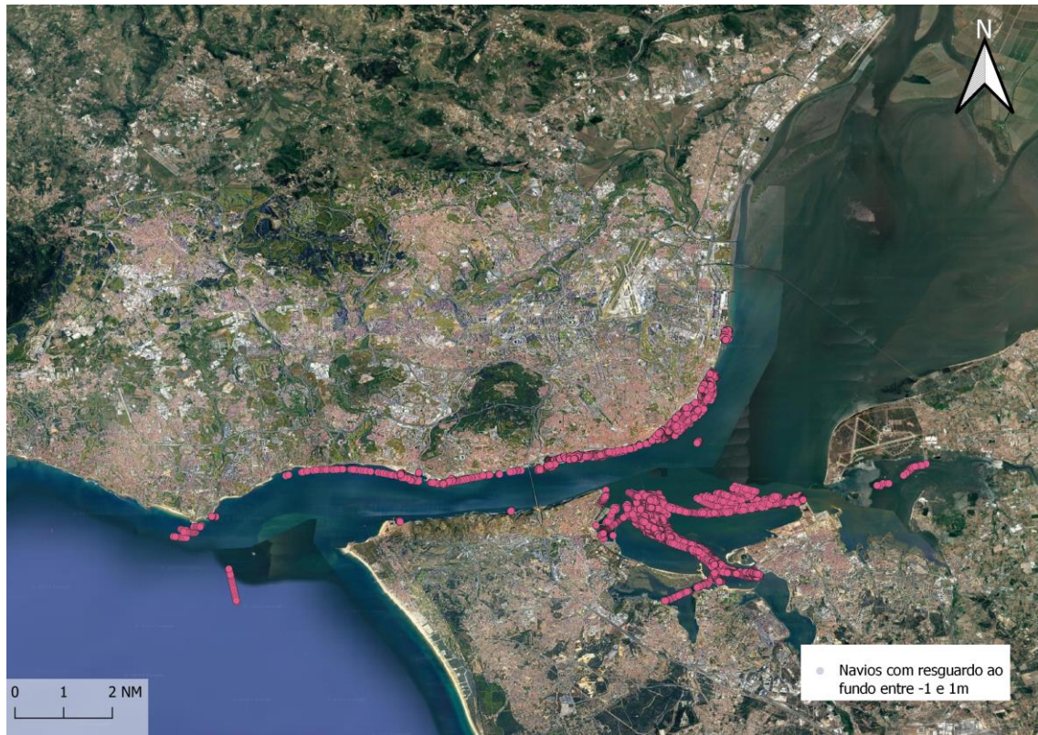
Figura 20- Locais onde existe menor resguardo ao fundo
