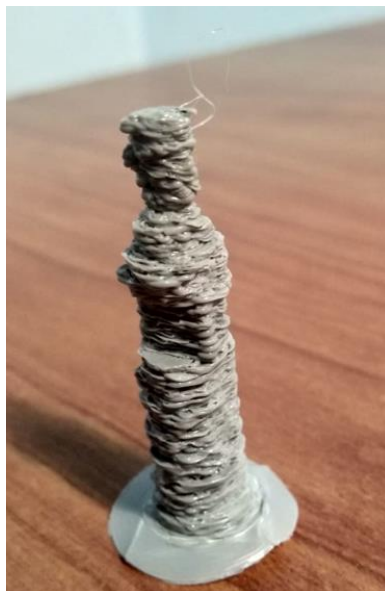
Fig. 53 - Impressão 3D do pino, onde demonstra as dificuldades de impressão devido ao dano do nozzle
