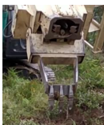
Figura 3 - Tipo de subsolador da alfaia Risutec SKB-180.
