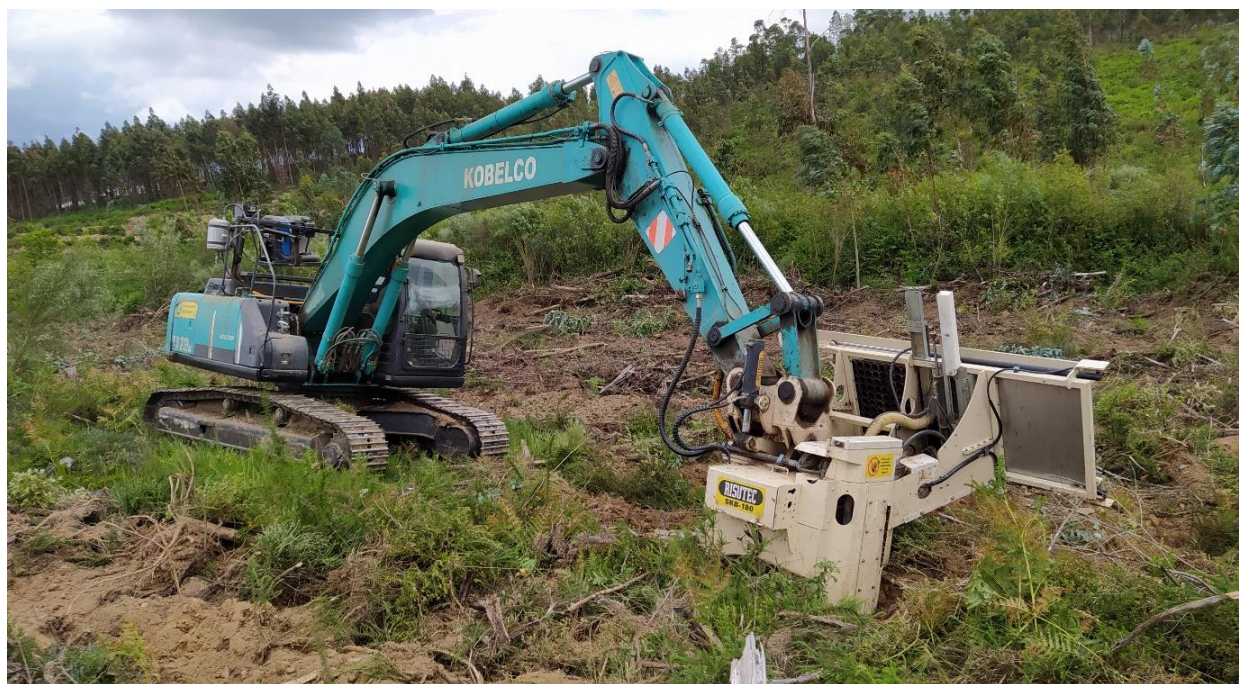
Figura 5 - Alfaia Risutec SKB-180 acoplada a giratória de rastos convencional.
