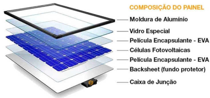
Figura 5.6 – Principais componentes utilizados no fabrico de um painel fotovoltaico.
