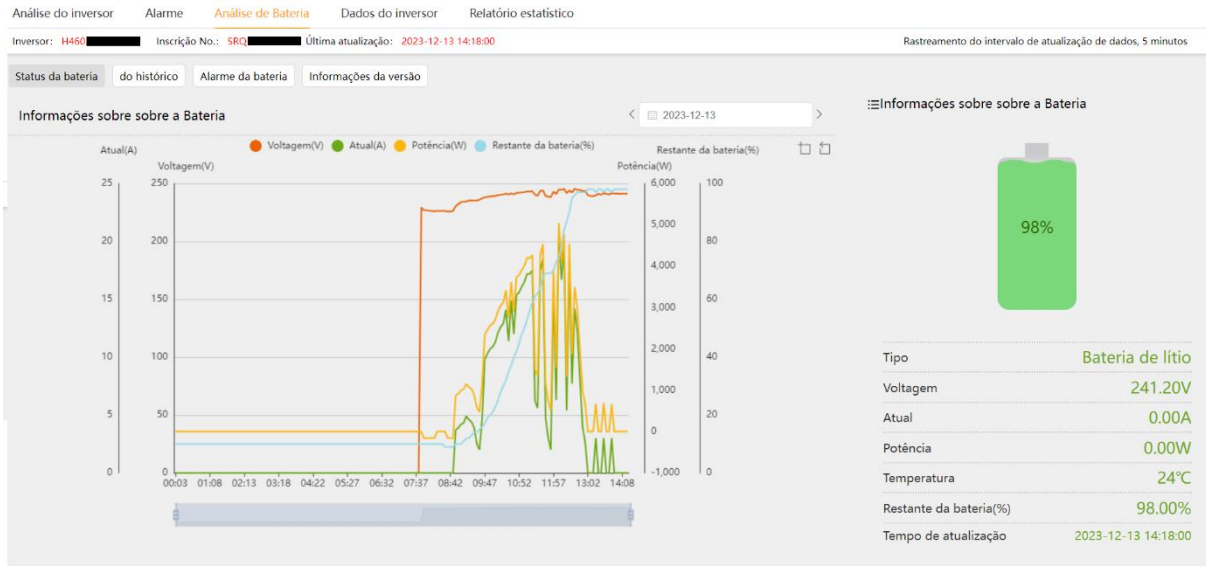
Figura 6.43 - Análise da Bateria, plataforma Solax Cloud.
