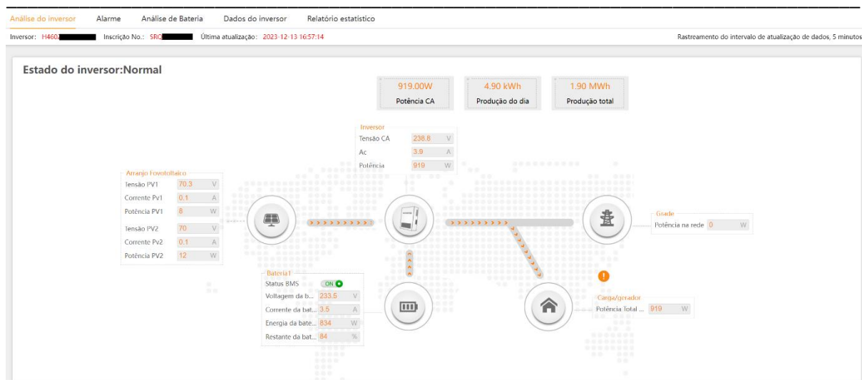
Figura 6.41 - Análise do inversor, plataforma Solax Cloud.
