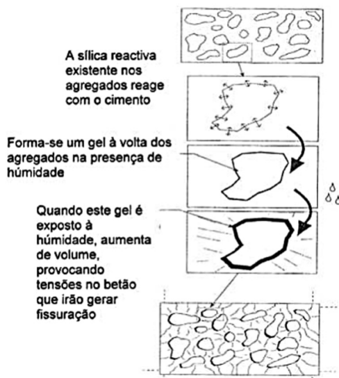
Figura 35 – Processo de fissuração por reações álcalis-sílica [5]
