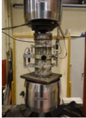
Figura 58 – Ensaio módulo de elasticidade [26]
