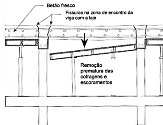
Figura 19 – Fissuras por remoção prematura do escoramento [5]
