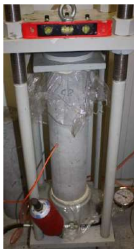
Figura 59 – Ensaio de fluência [27]
