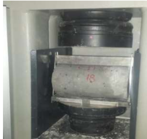
Figura 57 – Ensaio por compressão diametral [25]
