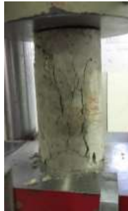
Figura 21 – Fissuração por compressão simples [8]
