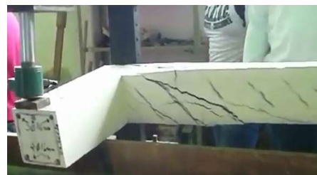
Figura 24 – Fissuração por torção [10]
