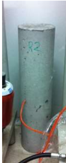
Figura 60 – Ensaio de retração [27]
