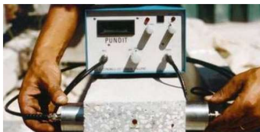
Figura 43 – Ensaio de ultra sons [17]
