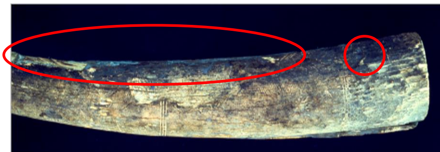
FIG. 51: Fotografia com UV, onde se encontra evidenciada a fluorescência característica de um adesivo envelhecido. (Autoria: Luís Piorro. 2013.)
