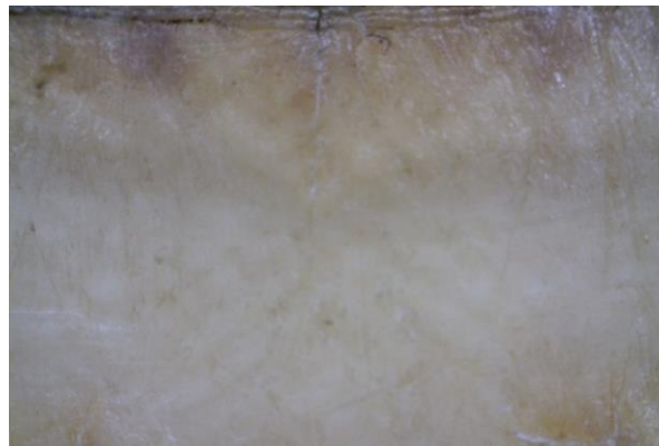
FIG. 27: Pormenor da base da campânula da “Trompa em marfim”, sendo visíveis as linhas de Schreger. Fotografia obtida com o dino-lite (amp. 65x) (Autoria própria, 2013.)
