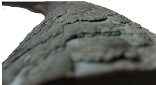
FIG. 56: Pormenor da esfoliação na campânula da trompa. (Autoria própria, 2013.)
