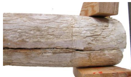
FIG. 99: Colagem das fendas com recurso a grampos. (Autoria própria, 2013.)
