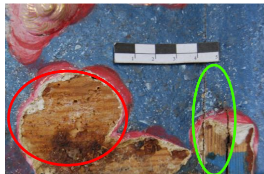
FIG. 153: Orifícios e galerias resultantes da actividade xilófaga e fragmento em risco de destacamento. (Autoria própria, 2012)
