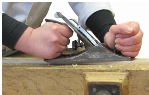
FIG. 88: Regularização da superfície com plaina. (Autoria própria, 2013.)
