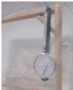
FIG. 93: Termo-higrómetro colocado no interior da câmara. (Autoria própria, 2013.)
