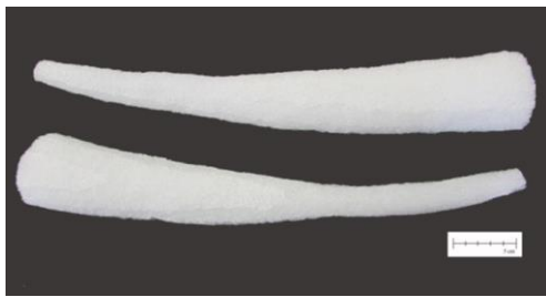
FIG. 70: Estrutura de enchimento em polietileno. (Autoria própria, 2013.)
