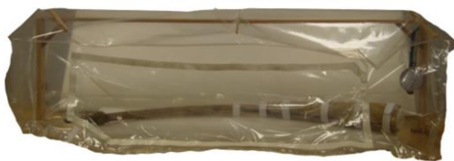
FIG. 95: Câmara de humedecimento com a trompa envolta em velcro no seu interior. (Autoria própria, 2013.)
