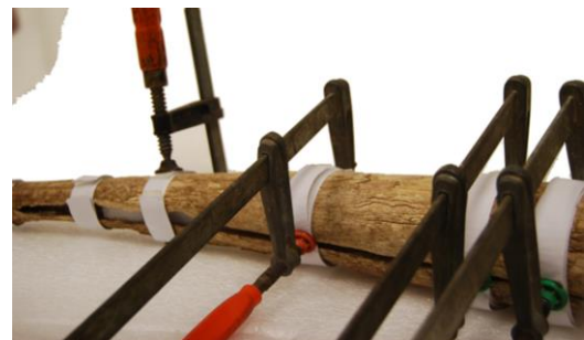
FIG. 96: Tensão aplicada nas paredes da campânula com grampos. (Autoria própria, 2013.)
