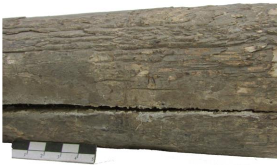
FIG. 53: Fenda longitudinal convexa. (Autoria própria, 2013.)
