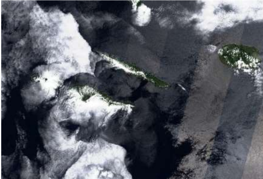
Figura 17 - Imagem multiespectral que mostra a impossibilidade de visualizar certas áreas devido à presença de nuvens
