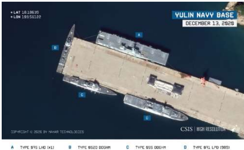
Figura 10 - Identificação da classe de 4 navios militares chineses, com recurso a uma imagem de satélite captada por um sensor ótico Fonte: https://www.csis.org/analysis/chinas-new-amphibious-assault-ship-sails-south-china-sea
