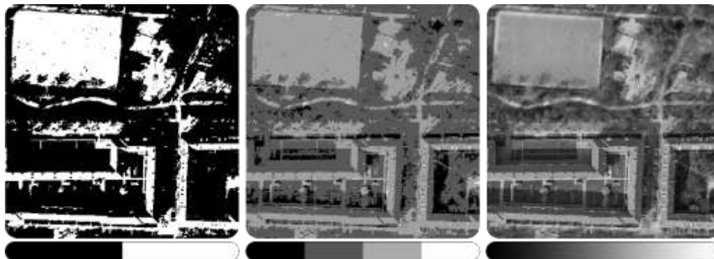
Figura 4 - Diferentes níveis de resolução radiométrica (1 bit, 2 bits e 8 bits) Fonte: https://blogs.fu-berlin.de/reseda/sensor-basics/
