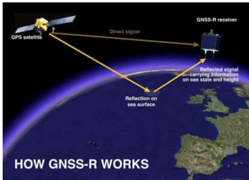
Figura 12 - Princípio básico de funcionamento de um sistema GNSS-R Fonte: https://phys.org/news/2016-02-sea-space-gps.html
