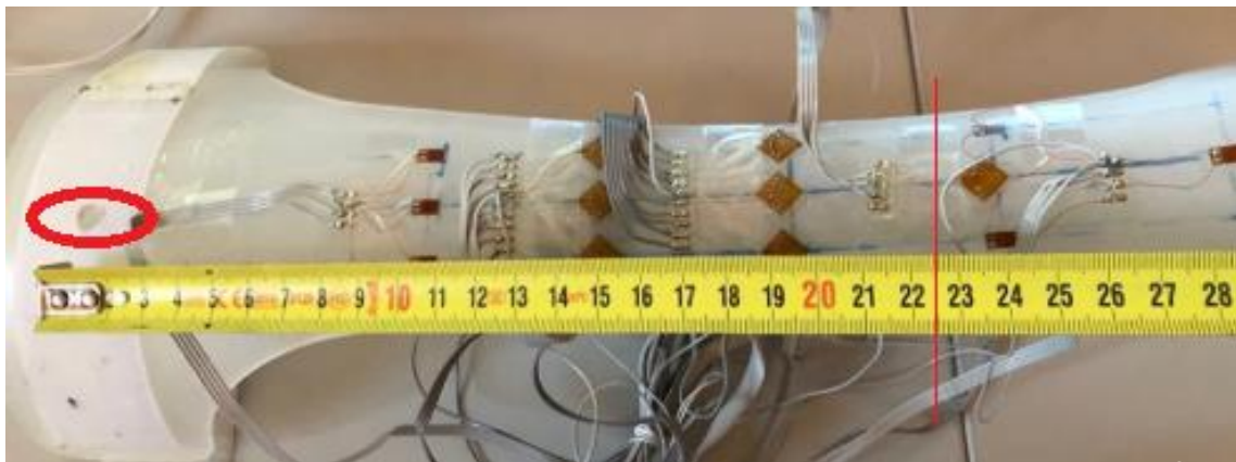
Figura 42- Posição inicial da AFO e local ideal para colocação do sensor.
