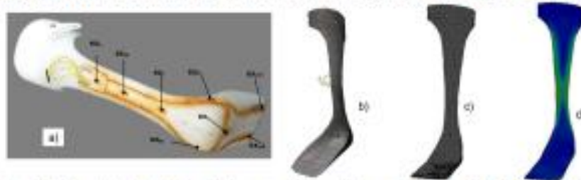
Figura 1. AFO considerada: a) Instrumentada com a sensores ópticos lineares; b) Modelo 3D da AFO; c) Malha de elementos finitos; d) Distribuição das deformações numa direção aproximada ao eixo da perna.
