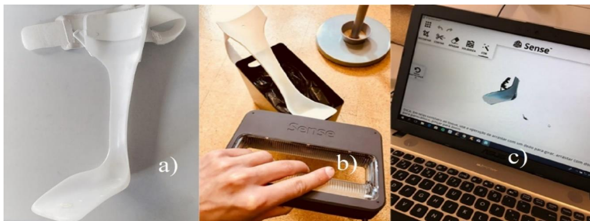
Figura 15- a) AFO considerada já com a aplicação do spray; b) Utilização do scanner; c) Obtenção do modelo 3D em software.
