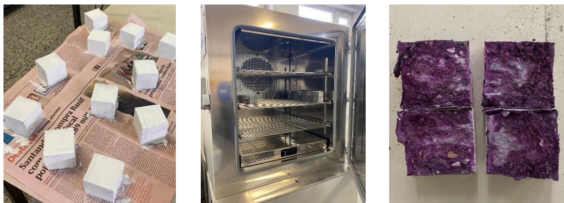
Figura 3.21 – Ensaio de Carbonatação: a) aplicação de revestimento/pintura; b) câmara de carbonatação acelerada; c) profundidade de carbonatação.
