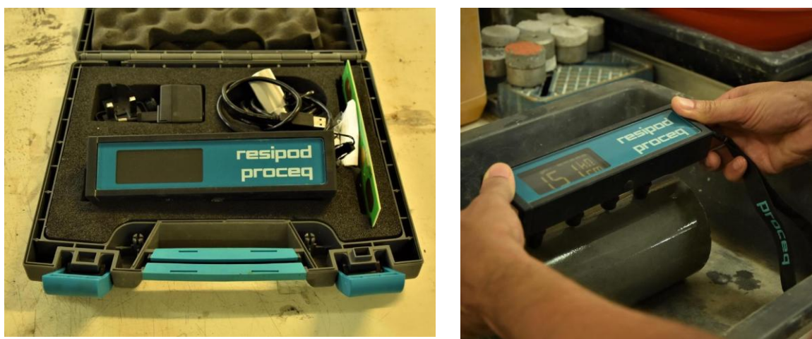
Figura 3.25 – Ensaio de resistividade elétrica: equipamento e procedimento de ensaio, respetivamente.
