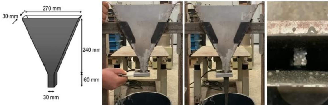
Figura 3.13- Ensaio de fluidez (mini funil-V).
