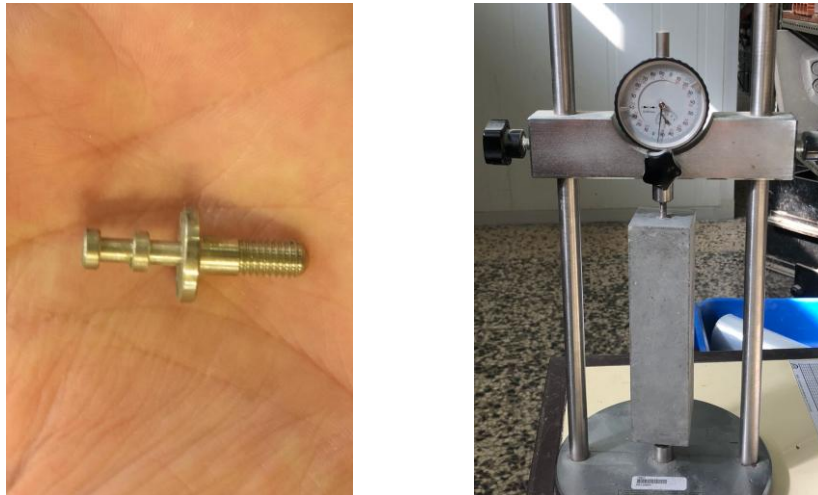
Figura 3.17- Inserts metálicos e medição da retração em provetes 40×40×160 mm 3 .
