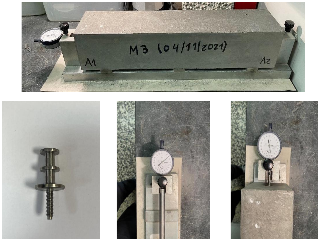
Figura 3.18- Inserts metálicos e medição da retração em provetes de 100×100×500 mm 3 .
