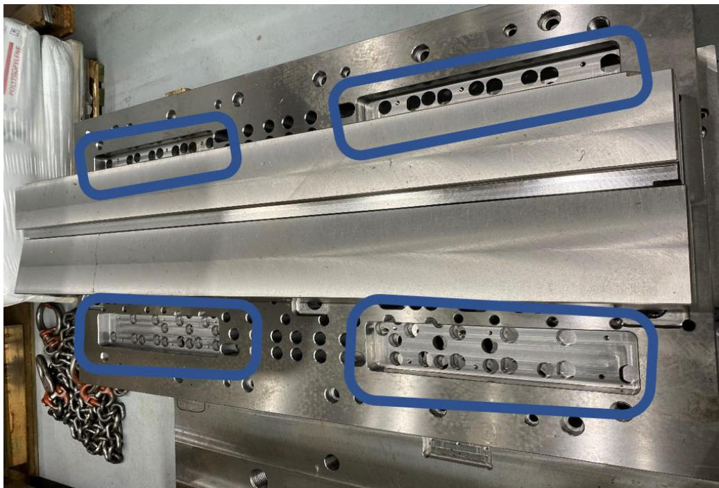
Figura 4.2 – Alojamento das tampas de acesso direto  s barras extratoras.
