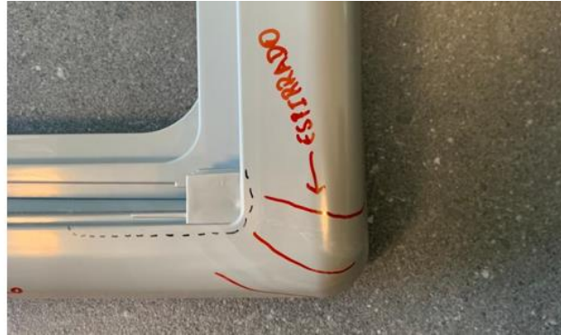
Figura 4.94 – Efeito de espirro visível na peça.
