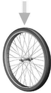
Figura 53 - Roda de bicicleta. Os vários raios distribuem o peso exercido sobre a roda. (fonte: ver anexo1)
