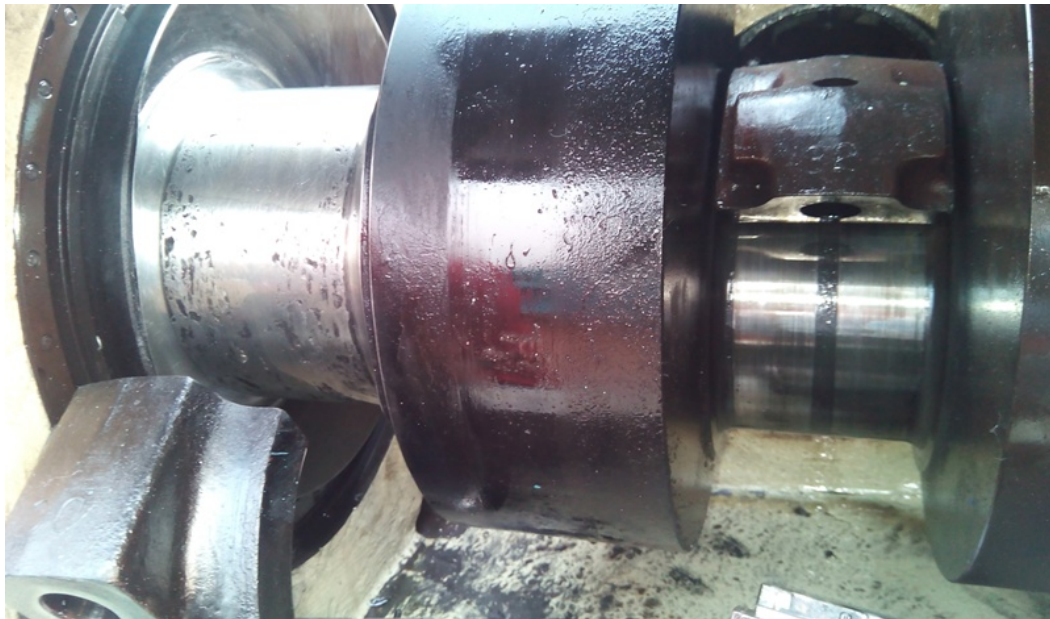
Figura 5.14. Zona desgastada da Cambota.
