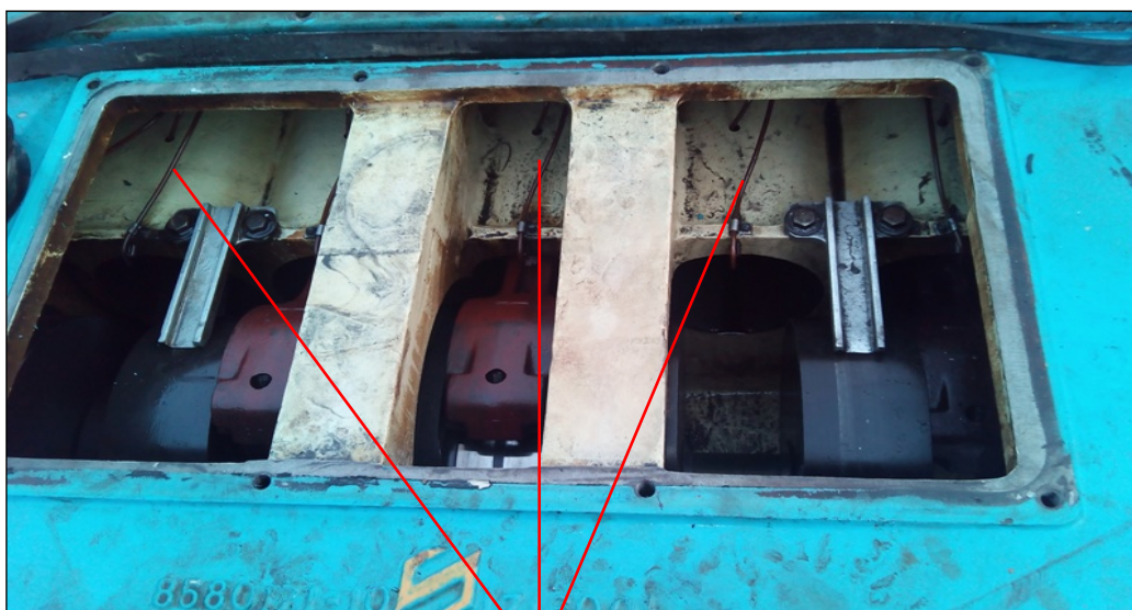
Sistema de lubrificação de baixa rotação (Biela-Cambota)
