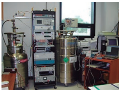
Figura 1. Sistema experimental compacto para realização do padrão da tensão de Josephson (cortesia do NIST).
