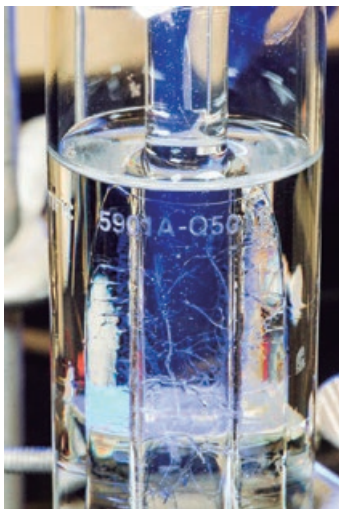
Figura 2. Célula de ponto triplo da água usada na realização do kelvin do SI (cortesia do NIST).
