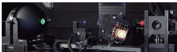
Figura 3. Bancada para realização de unidades fotométricas utilizada pela PTB (cortesia da PTB).
