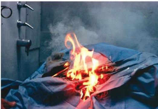
Figura 6 – Após 14s. da aplicação do eletrodo monopolar, surge chama na cobertura cirúrgica. Fonte: BARKER, Steven PhD, et.al. - Fire in Operating Room: A case report and laboratory study. Anest. analg. 2001; 93:960-5.
