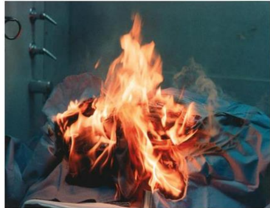
Figura 7 – Após 24s. da aplicação do eletrodo monopolar, toda a zona da cabeça do manequim e cobertura cirúrgica estão em chamas.
